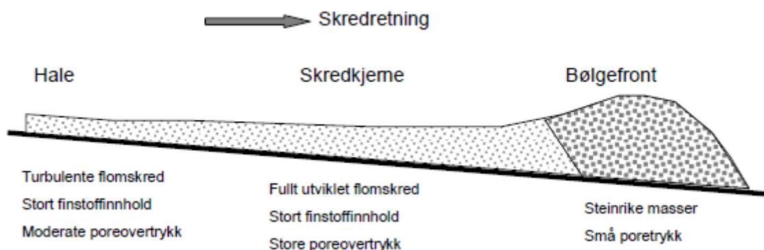
Figur 2.2 Skisse av hovedkomponentene i et flomskred (Norem og Sandersen, 2012).
