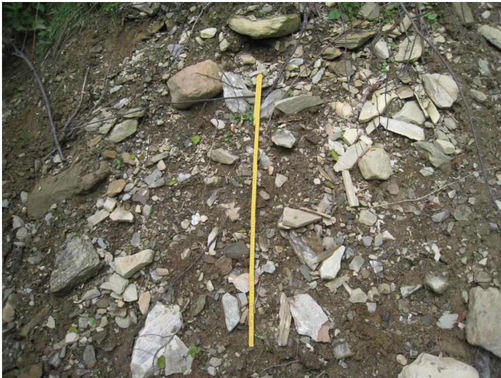
Figur 5.22 Kornstørrelsen i utløsningsområde 1. Finkornete sedimenter og steiner var de dominerende kornfraksjonene. Gul tommestokk tilsvarer 100 cm. Foto: Daniel Haugen Edvardsen.
