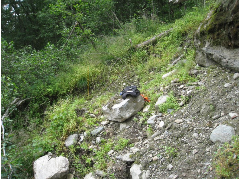
Figur 5.28 Ulike kornstørrelsene i utløsningsområde 4. Tykkelsen varierte fra 40- 80 cm. Gul tommestokk tilsvarer 80 cm. Foto: Daniel Haugen Edvardsen.
