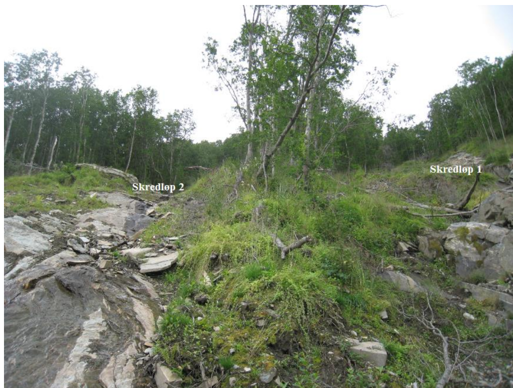
Figur 5.32 Retningen til skredløp 1 og 2 nedover mot møtepunkt 2. I dette partiet besto skredløpene av oppstikkende berggrunn, der skredavsetningene i hovedsak var steiner og blokker. Foto: Daniel Haugen Edvardsen.
