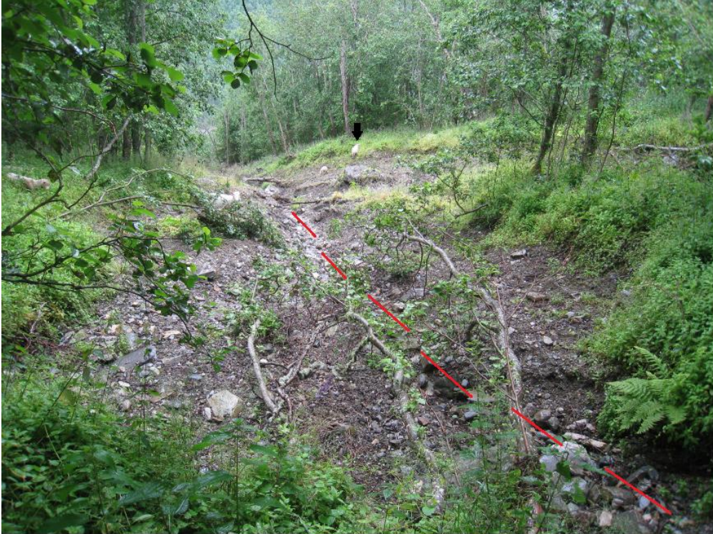
Figur 5.24 Utløsningsområde 2, sett fra skredkanten og nedover dalsiden. Rød stippet linje viser det dypere partiet der det ble observert spor etter rennende vann. Treet som ligger i utløsningsområdet har veltet ut og ligger med lik orientering som skredretningen. Svart pil markerer sau som målestokk. Foto: Daniel Haugen Edvardsen.
