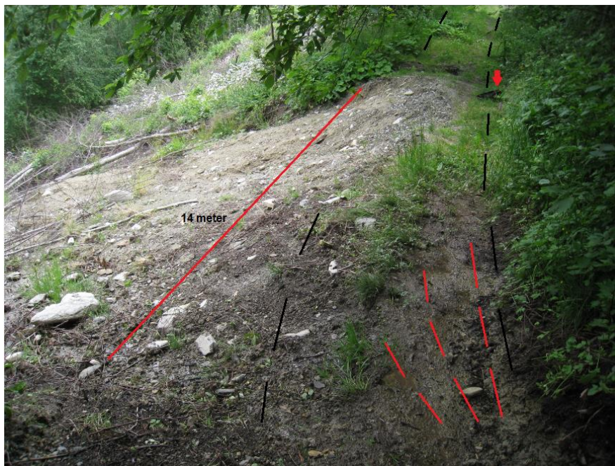
Figur 5.13 Utløsningsområdet til skred 2 langs den ytterste skulderen til skogsbilveien. Skredsåret ble målt til å være ca. 14 meter bredt (markert med rød strek). Rød pil markerer sekk som målestokk, mens de røde stiplede linjene viser hvor det ble observert spor etter rennende vann langs det indre partiet til skogsbilveien i retning ned mot utløsningsområdet. Skogsbilveien er markert med svarte stiplede linjer. Foto: Daniel Haugen Edvardsen.
