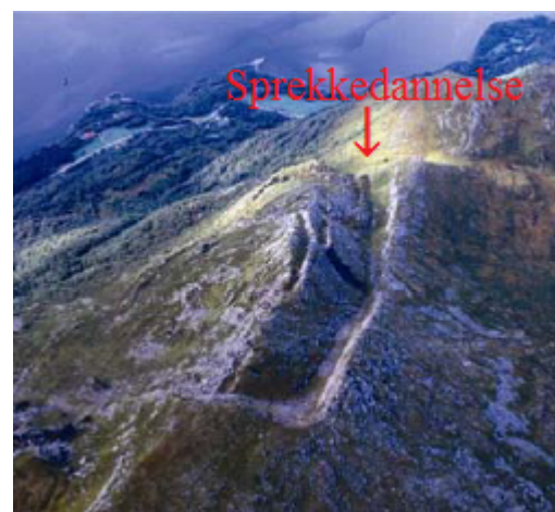
Figur 2.4: Sprekkdannelse som gir lange og bratte skrenter ved Oppstadhornet, Møre og Romsdal (Devoli et al., 2011)
