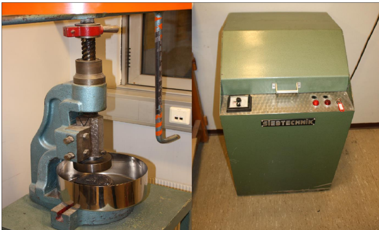
Figur 20: Bildet til venstre viser grovknuseren "Fly Press Rock Crusher". Her ble prøven mekanisk knust ned ved hjelp av at stempelen ble skrudd ned gjentatte ganger inntil prøvene kunne knuses videre ned i maskinen til høyre på figuren. Maskinen til høyre er en "Siebtechnik skivesvingmølle" der prøvene ble nedknust slik at det ikke var mulig å kjenne korn mellom fingrene. Erfaringsmessig har denne kornstørrelsen gitt det beste resultatet. Foto H. Velve.
