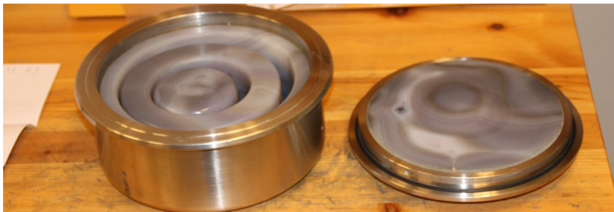
Figur 21: Bildet viser skålene av agat som knuser ned prøvene før de kunne brukes i XRD-analysen. Materialet ble plassert mellom ringene til venstre, og lokket til høyre påsatt. Deretter førte gravitasjonskraften til at prøven ble nedknust til ønsket størrelse. Foto H. Velve
