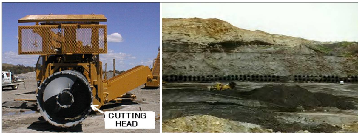
Figur 14: Bildene viser augermining i et dagbrudd, maskinen til venstre er forholdsvis liten med en borhodediameter på ca. 1 m. Til høyre sees resultatet etter boringen, etter ("Coal mining and geology").
