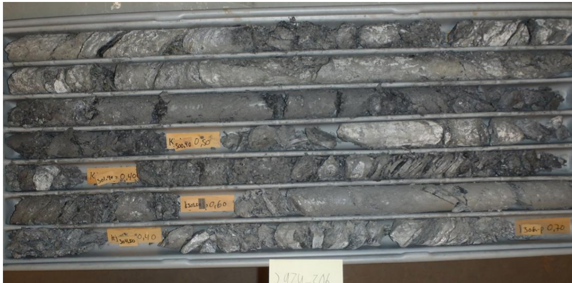
Figur 4-15: Krågøy Nord hull B (297 m - 306 m). Oppknust bergmasse og sleppemateriale (Vegvesen 2011)
