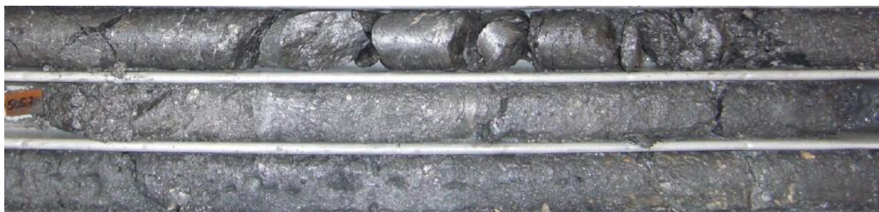
Figur 4-13: Hestholmen ved ca.506 m. Leirerik knusningssone, siltig til sandig breksjer (Vegvesen 2011).
