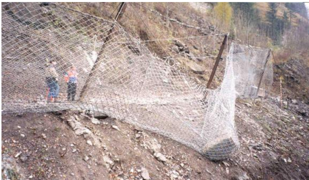
Figur 24 - Fullskala test av eit fanggjerdet (foto: K. Moen, Multiconsult).
