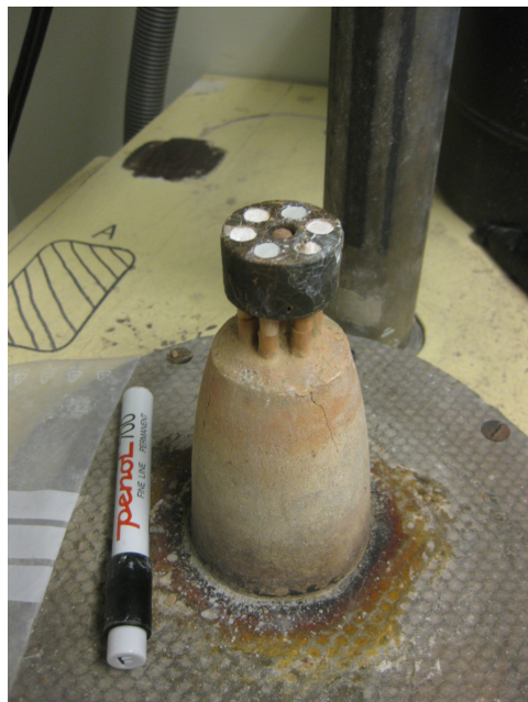
(b) To parallelle prøver plassert i analyseapparatet med referansemateriale til høyre. Foto: Mari Lie Arntsen.
