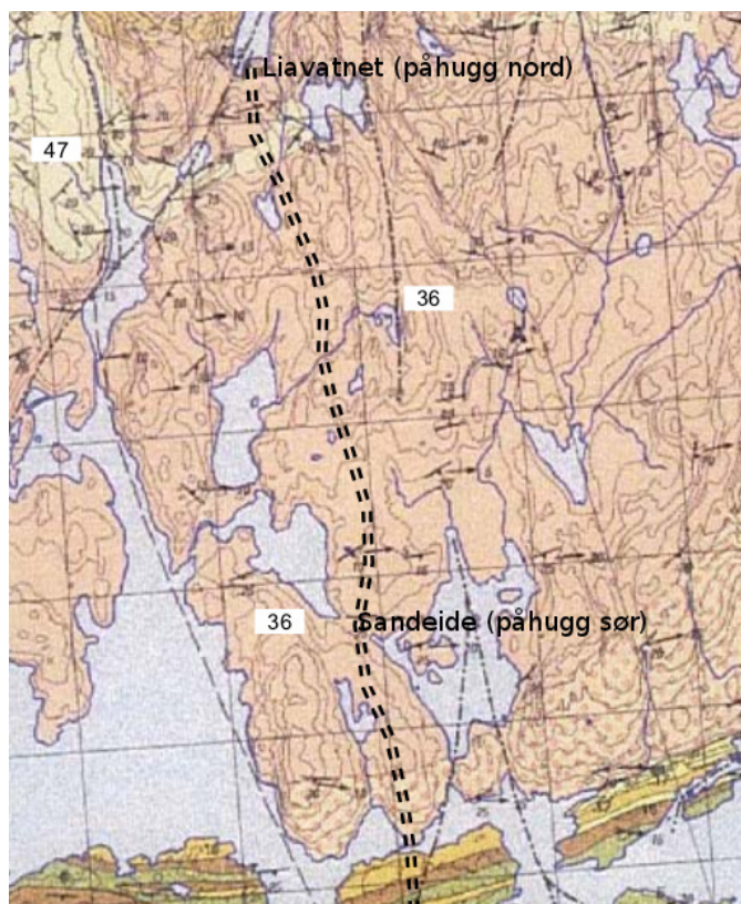
Figur 5.4 – Berggrunnskart med inntegnet tunneltrasé.
