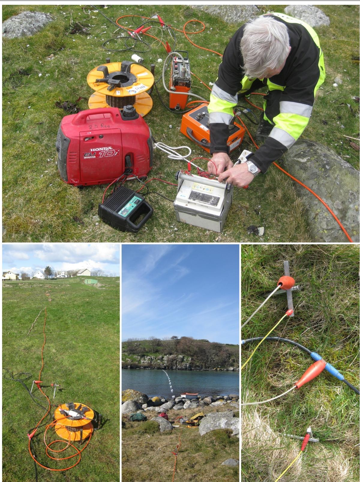
Figur C.7: Bilete frå resistivitetsmålingar. Oppe; Oversikt over utstyr, Venstre; Kabelutlegg, Midten; Utlegg i fjord, Høgre; Elektrodar med koblingar
