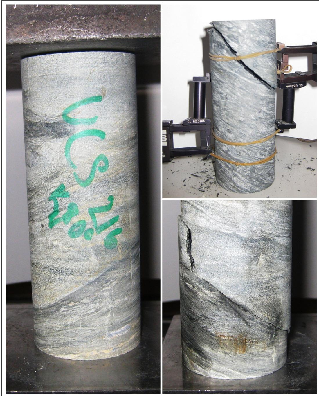
Figur 4.14: Venstre: Kjerneprøve med grensesjikt mellom grønnstein og svartskifer; Opp: Brudd langs lagdeling under testing av Youngs modul; Nede: Brudd langs bergartsgrense under testing av trykkfasthet.
