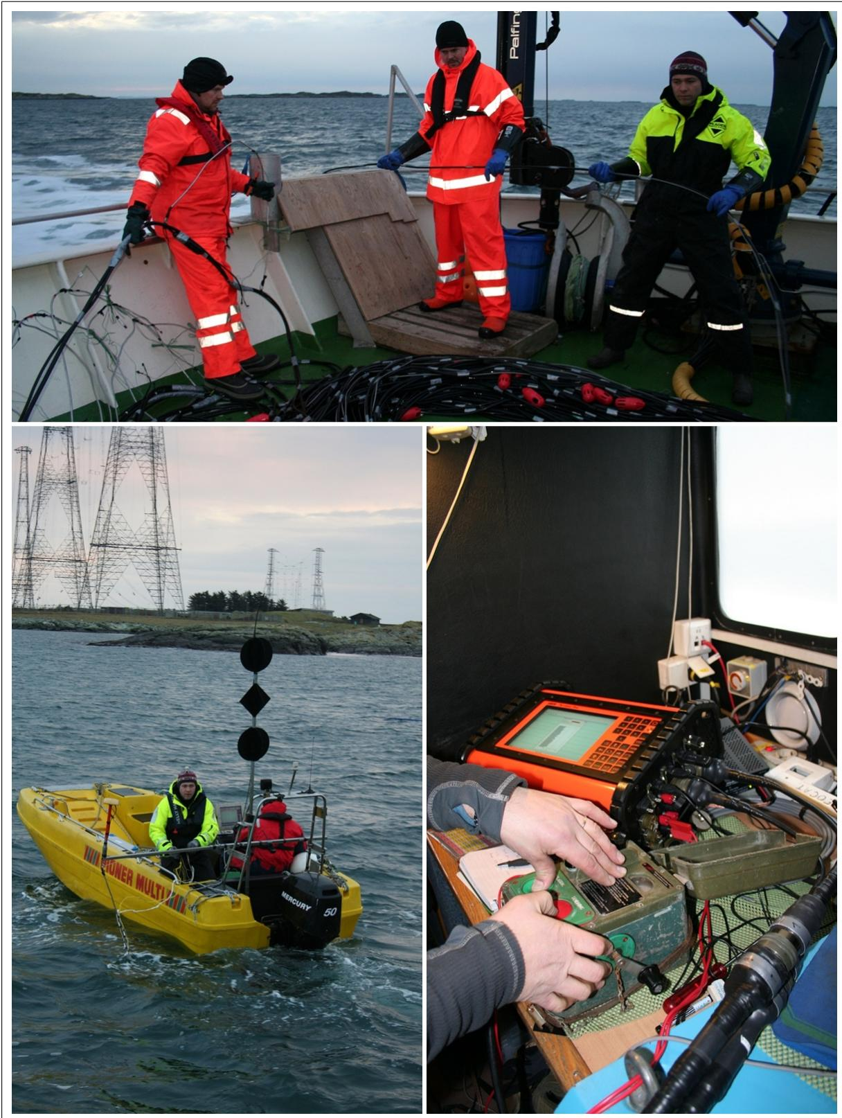
Figur C.6: Bilete frå refraksjonsseismikk. Opp; Utlegg av kabel, Venstre; Posisjonering av kabel, Høgre; Detonasjon av skot.
