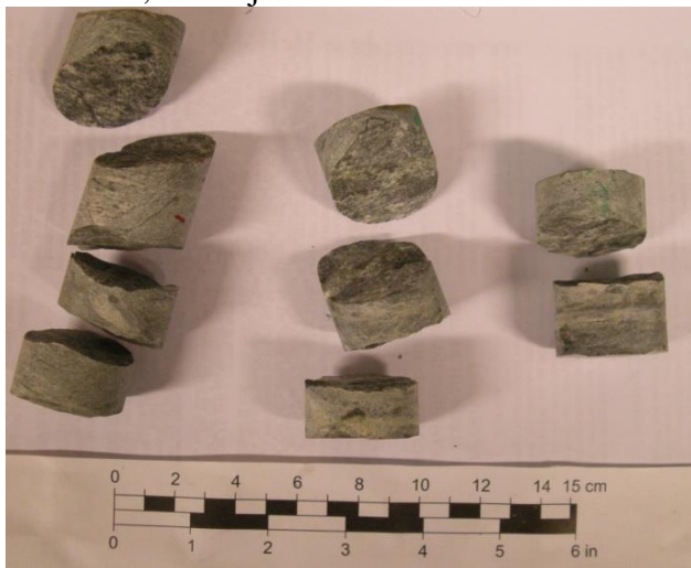
35,5mm kjerner etter diametraltest
