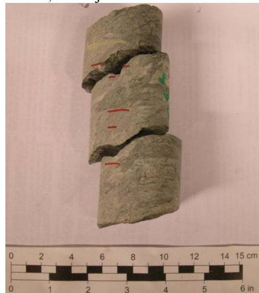
49,2mm kjerne etter diametraltest
