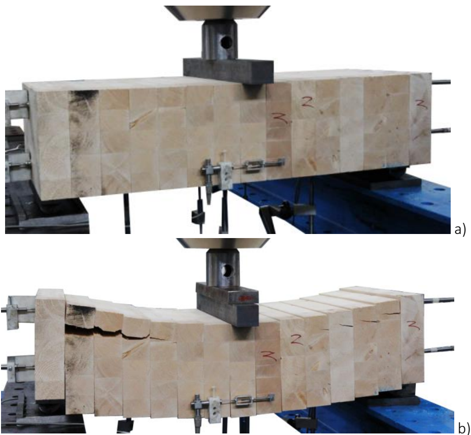
Figur 8.15: M62-15-880: Deformasjon av dekke
