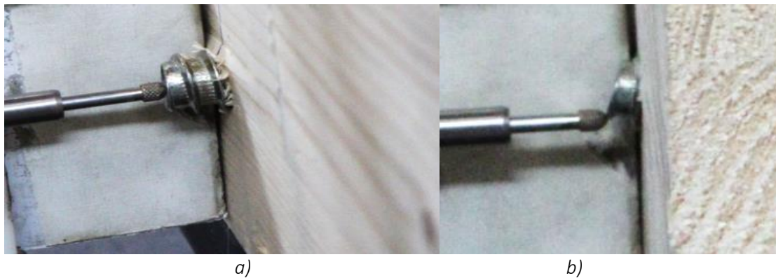
Figur 8.17: M62-15-880: Forskyvning gjengestag. Nede til høyre. GS-HN
