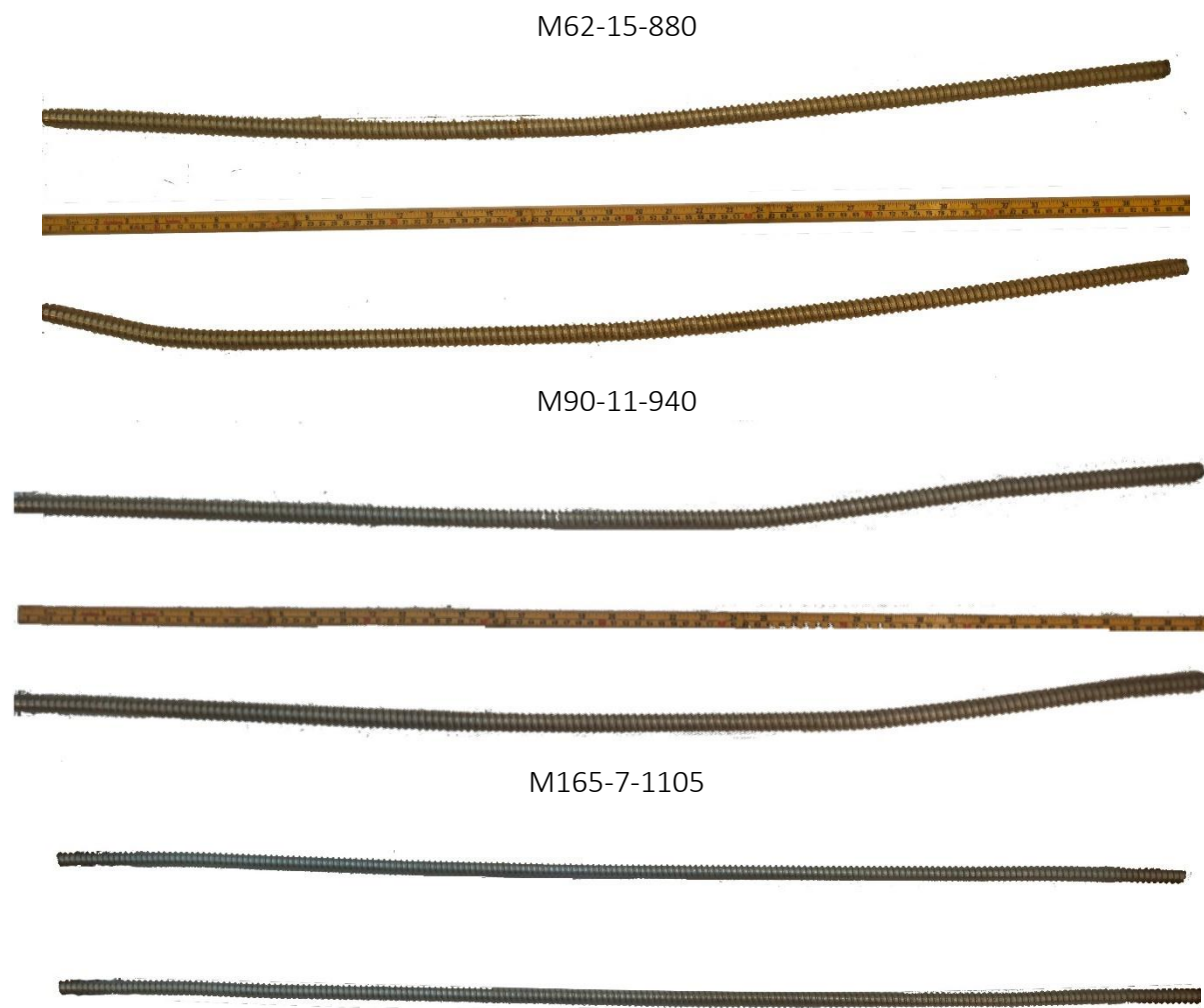
Figur 8.28: Deformasjon Gjengestag – Momenttester
