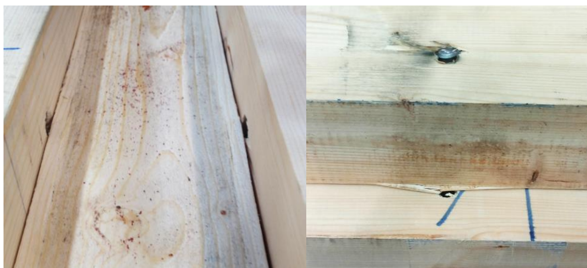
a) b) Figur 8.11: S90-90-3-3: Deformasjon av teststykke
