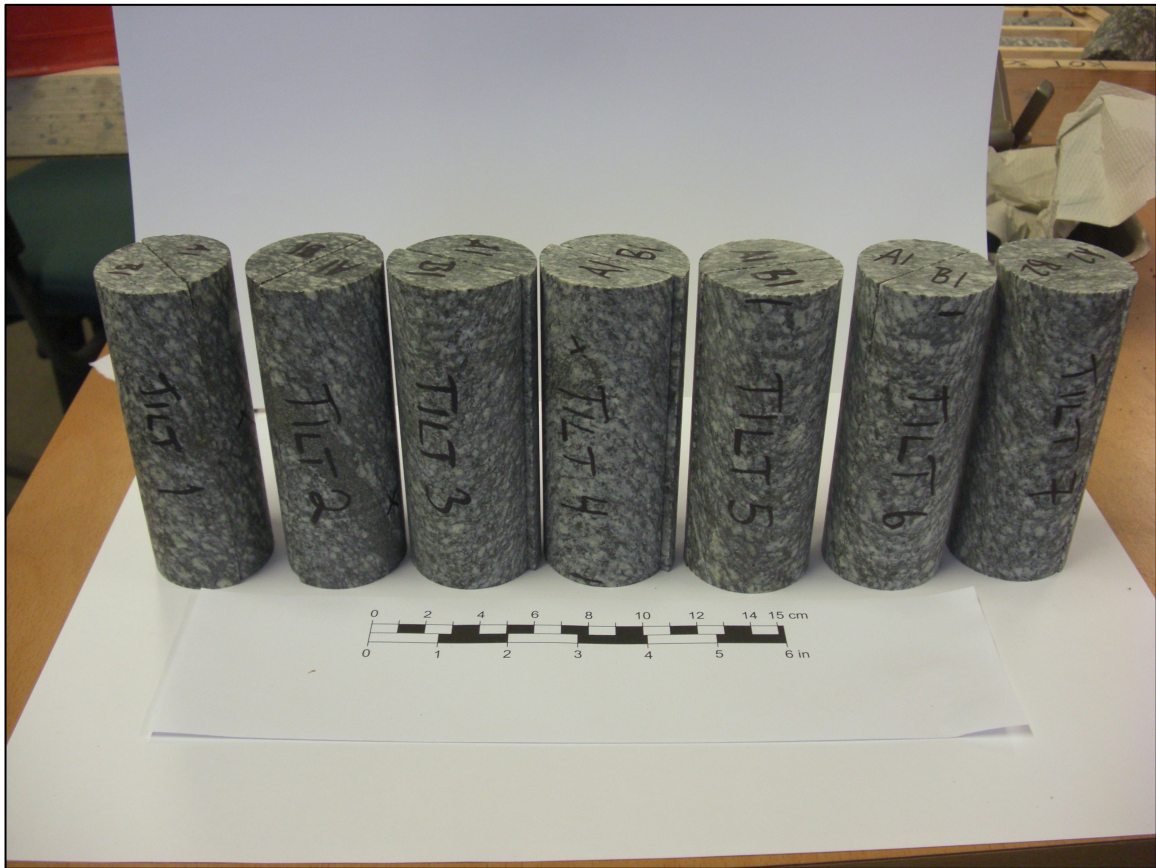
Figur E-13: Kjerneprøver benyttet i tilt-testen.
