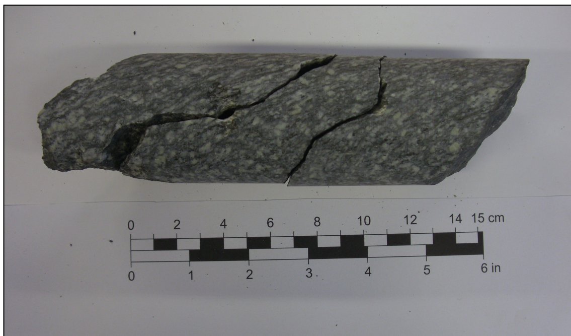
Figur E-11: Brudd langs foliasjon ved testing parallelt svakhetsplan.
