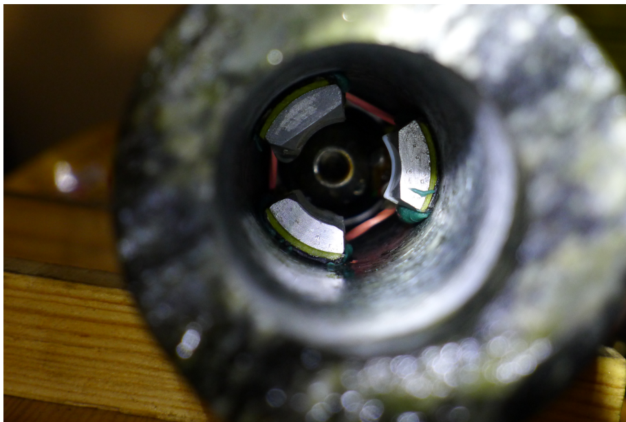
Figur 6-3: Strekklappenes plassering i borhullet (Foto: Pöyry SwedPower, 2012). Bildet er av en overboret kerne fra Oppdølsstranda.
