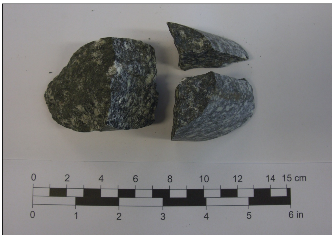
Figur E-12: Brudd ved testing normalt på svakhetsplan.
