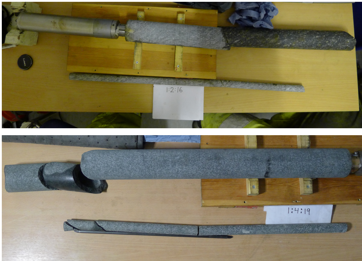
Figur 6-6: Overborede kjerner fra Oppdølsstranda (Foto: Pöyry SwedPower, 2012).
