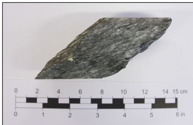
Figur 3-2: Bruddflate etter punktlasttesting. Bruddet følger foliasjonsretning.
