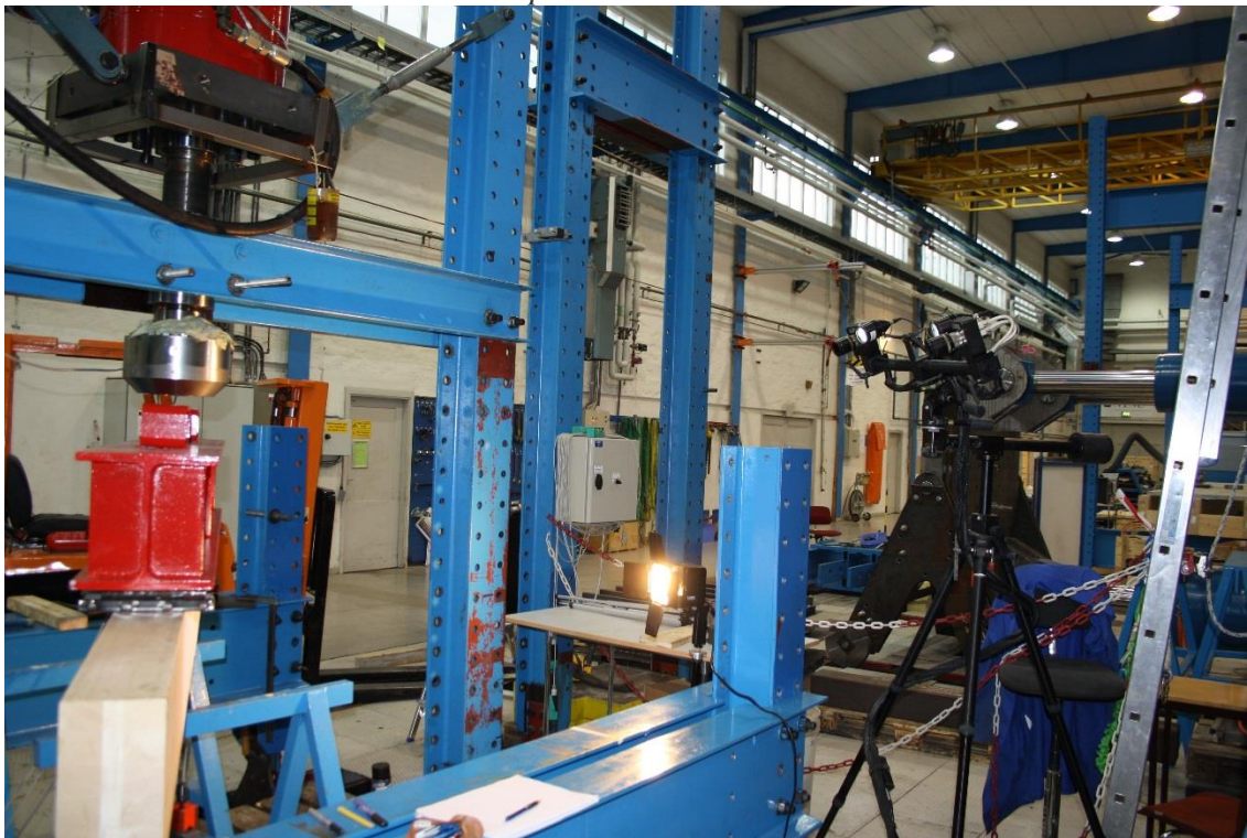
Figur V4-8: ARAMIS-skanneren satt opp mot bjelkeskjøten i testriggen.
