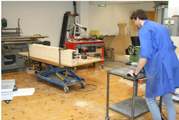
Figur VI-17: Maskinen fra Bosch ble lagt på et rullebor. Ved å juster heve-senke bordet som bjelken lå på kunne man sikre at man boret i vater og at man slapp i å løfte på den tunge maskinen
