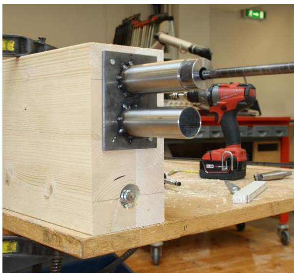
Figur 5-6: Styrebraketten festet til bjelkeenden men 15mm boret ført inn i braketten.
