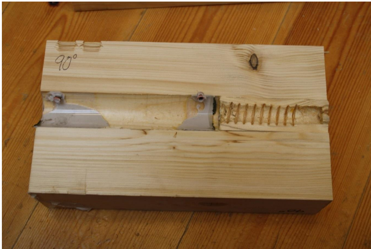
Figur V2-9: Noe lekkasjer ved begge gysehull. Lekkasjen i topp av hull var så stor at det begynte å renne ut fra hullet. Lekkasjen ble tettet utvendig. Hylsen var helt full av lim ved inspeksjon.
