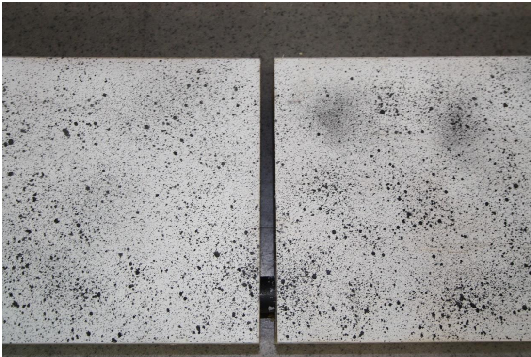
Figur V4-15: Bjelkeskjøt etter at den ble tatt ut av testrigg. Uttrekk i bunn har gitt store forskyvninger.
