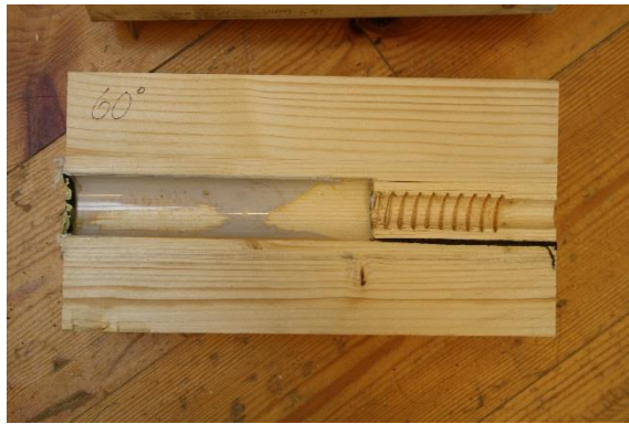
Figur V2-10: Noe lekkasjer utenfor hylse som har spredd seg fra gysehullet i topp. God fylling med lim i hylsen.
