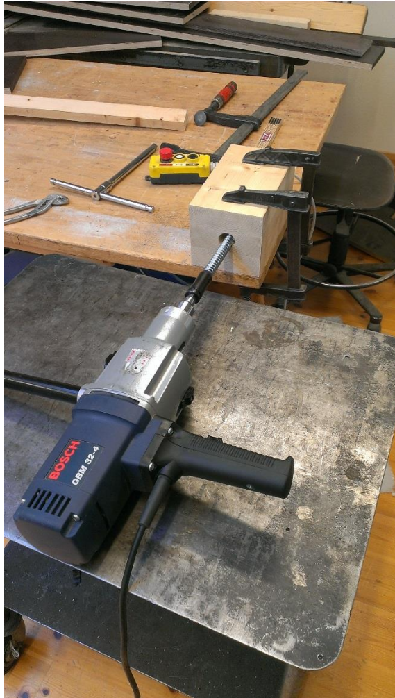
Figur VI-7: For å skru inn gjengestaget ble maskinen lagt på et rullebord. Klossen ble festet til et heve-senke bord slik at man fikk skudd inn i vater.
