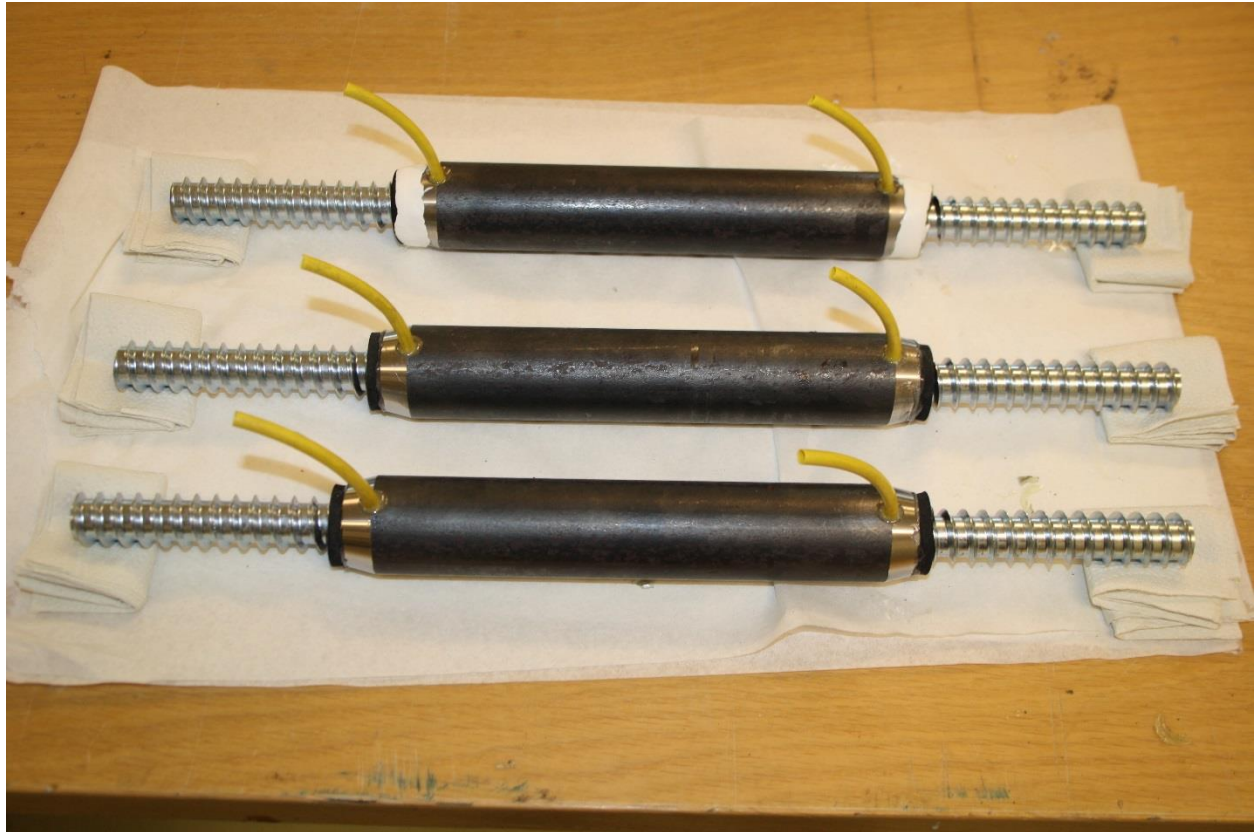
Figur VI-12: Hylseforbindelsen ferdig produsert klar for liming. Pakningene på hylsen øverst i bildet slapp i det vi gjenget inn skruen. Det ble derfor besluttet å tette med silikon, og derav det hvite rundt pakningene.
