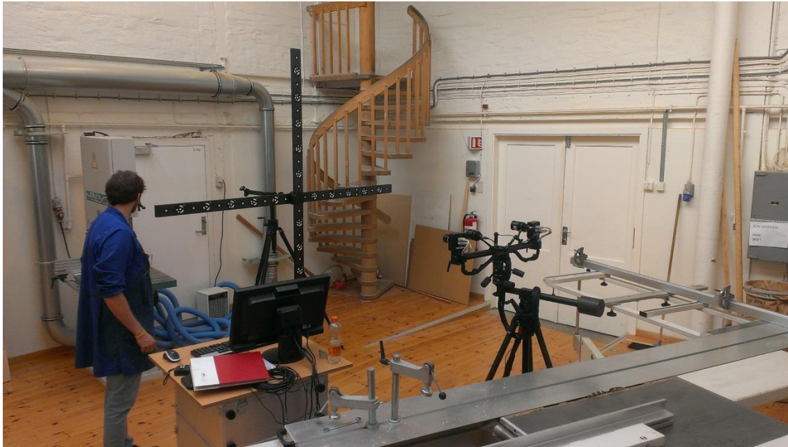
Figur V4-9: Kalibrering av ARAMIS-skanneren. Prosedyren foregikk ved å la skanneren fokusere på kalibrerings krysset i 28 forskjellige posisjoner.
