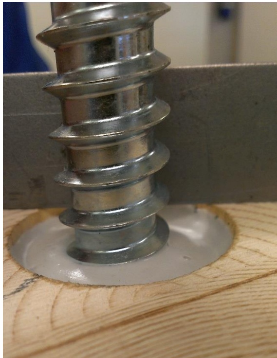
Figur V3-6: Bildet viser hvordan limet har satt seg over herdetiden på 7 døgn. Ved gysing var limet i flukt med kanten på hullet.
