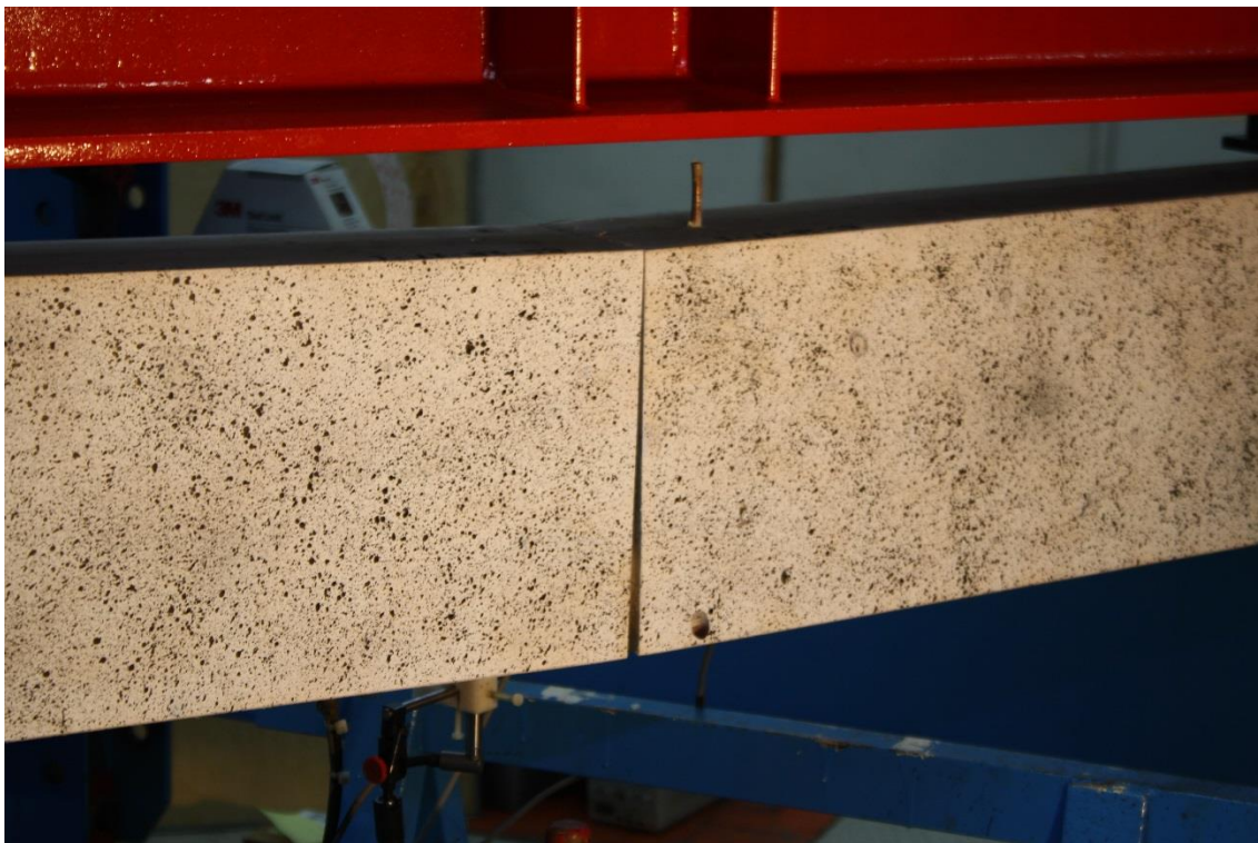
Figur V4-21: Betydelig rotasjon etter første krafttap som oppstod ved 74,9 kN.
