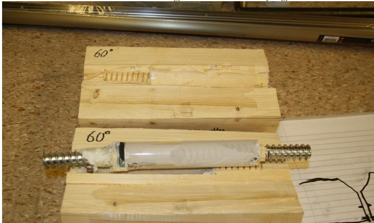
Figur V2-6: Hylse med store tomrom i. Dette pga av lekkasje mellom gummipakning og hylse da pakningen slapp. Feilslått test mhp fylling av hylse.
