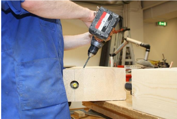
Figur VI-23: Hullene til gyserørene ble boret for hånd ved at en siktet etter en siktestrek på bjelkeenden. Hull til innboringen ble målt og streket opp ved hjelp av en vinkel og en blyant.
