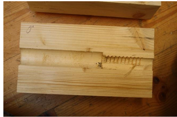
Figur V2-11: Ingen lekkasjer mellom hull og hylse. Her ble hullene i hylsen boret samtidig som man boret gysehullene i treklossen. Dette sikret perfekt treff på gysehullene og resulterte her i null lekkasje.
