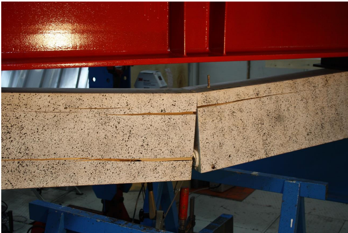
Figur V4-23: Brudd i bjelken.
