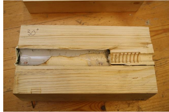
Figur V2-14: Lekkasje fra øve gysehull. Overgang hull i treklossen og hylse ble også her tettet med silikon på forhånd. Dette sikret at limet ikke rant ut av hullet, men heller rant inn gjennom hullet.
