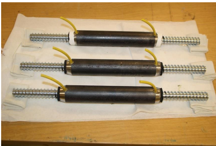
Figur 5-5: Hylseforbindelsen ferdig produsert med gummipakninger og slanger for gysing.
