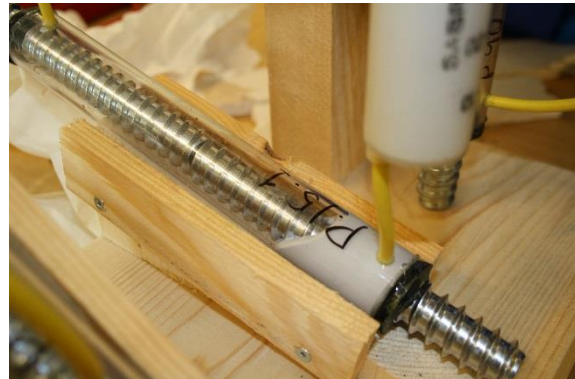
Figur VI-2: Gysing av lim i gjennomsiktig hylse
