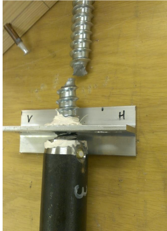
Figur V3-5: Brudd i skrue, test 6, hylse nr.6
