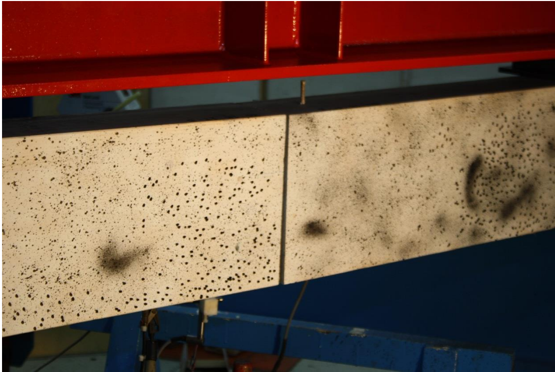
Figur V4-19: Bildet er tatt etter at brudd oppstod. Rotasjon lite synlig for det blotte øye.
