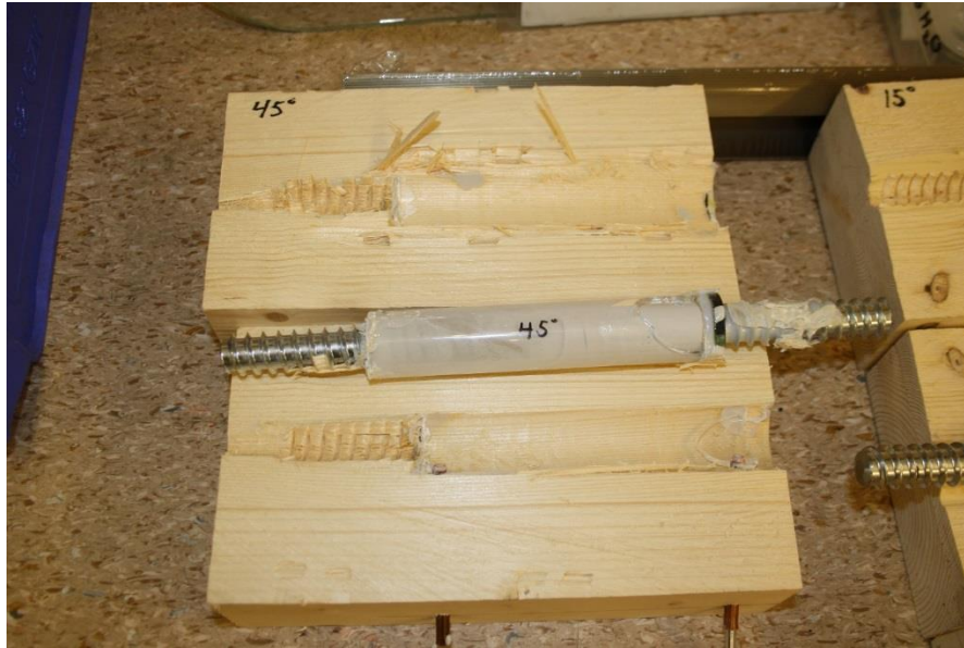
Figur V2-3: Ingen tegn til lekkasje rundt gysehullene. Heller ingen lekkasje av lim i bunn av hylsen hvor det ble brukt en pakning av silikon. Pga slipp mellom gummipakning og akrylrør har noe lim kommet ut i enden (høyre) av hylsen. Hylsen var likevel fylt opp med lim.
