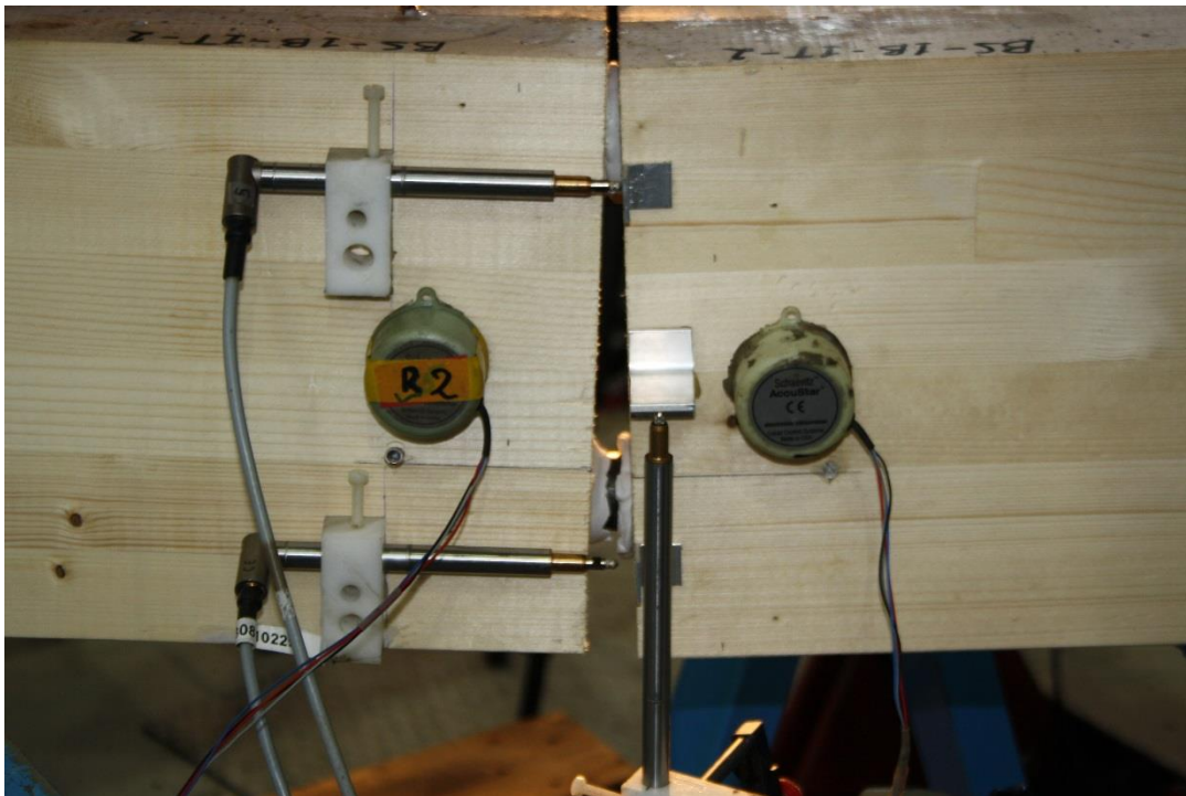
Figur V4-18: Deformasjonen i bunn var så stor at det overgikk måleområdet til forskyvningsmåleren.
