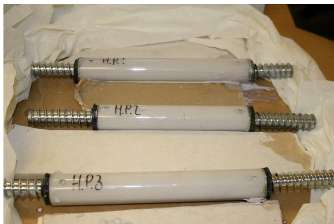
Figur 4-1: Hylsene som ble gyst i første test. Luftflommer ble observert rundt gysehullene etter herding.
