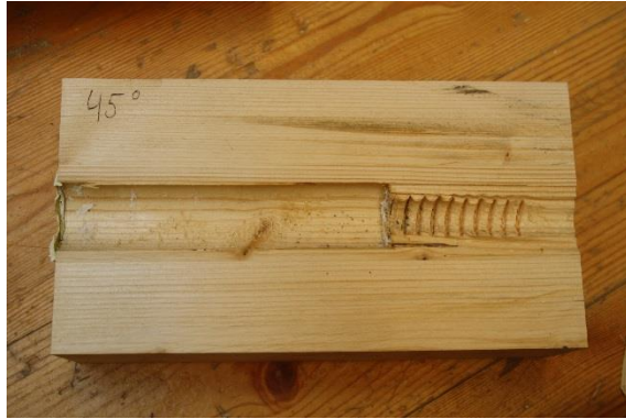
Figur V2-13: Hylsen viser ingen tegn til lekkasje. Også her ble gysehullene boret samtidig som hullene i hylsa som sikrer perfekt treff. Her ble det i tillegg brukt silikon på enden av hylsa i ytterkant for å sikre at evt. lekkasje ikke rant ut gjennom hullet.
