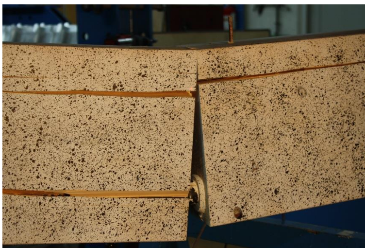
Figur 5-16: Splitting parallelt med fibrene etter at bjelken hadde fått store rotasjoner.
