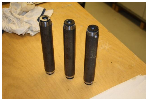
Figur VI-11: Påliming av gummipakninger. Araldit rapid ble påført begge kontaktflatene før liming. Limet fikk så stå å herde i minimum en time i vertikal posisjon før det ble tatt videre til innskruing av gjengestagene fra SFS Intec.
