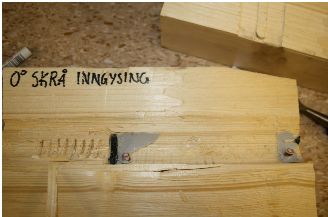
Figur V2-4: Noe lekkasje av lim ved gysehull. Pga lite opprom mellom hylse og treverk er det kun små mengder som har kommet ut.
