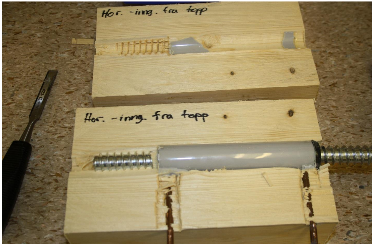
Figur V2-5: Noen små lekkasjer ved gysehull. Ingen lekkasje mellom pakning og skrue. Pakning av silikon i bunn. Men usikkert om lim rundt gysehull i bunn kommer fra gysehullet eller lim
