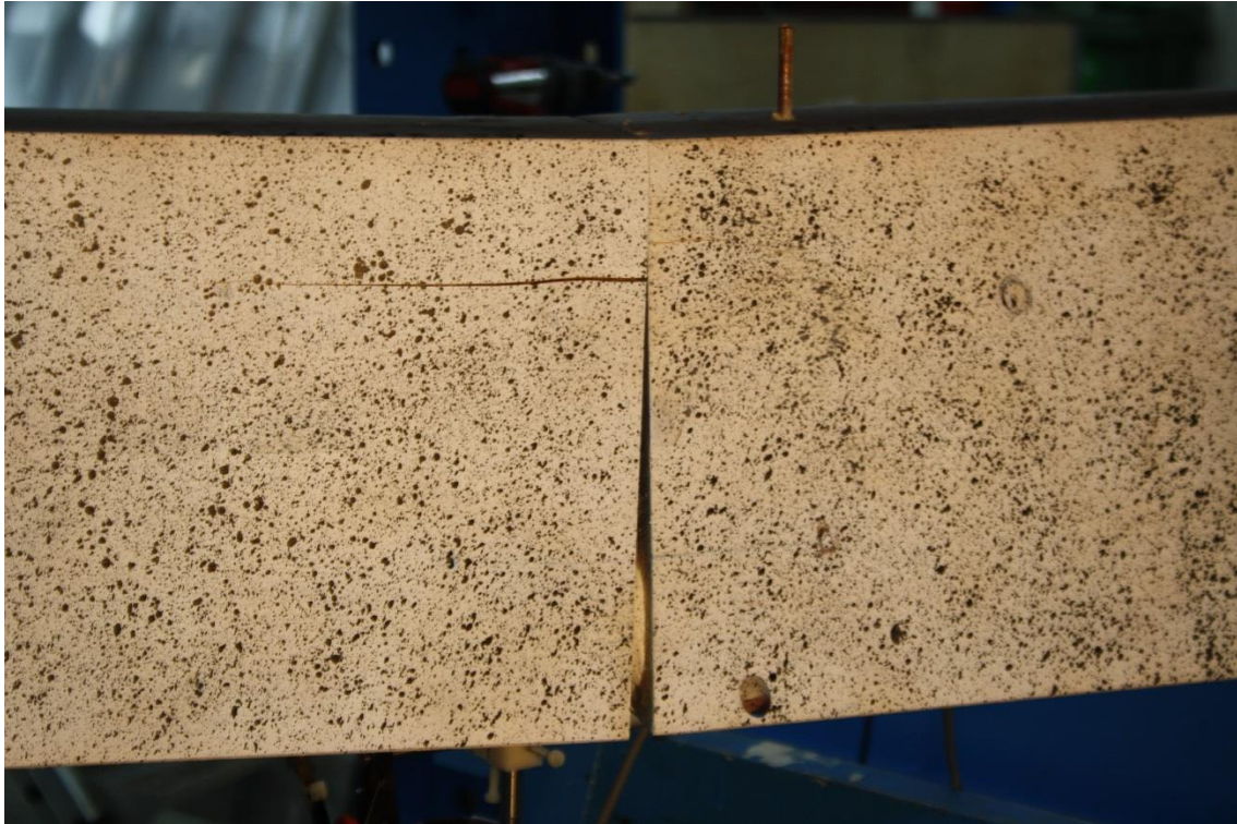
Figur V4-22: Sprekk i topp oppsto etter at bjelken hadde rotert så mye at det oppsto kontakt mellom treverket i toppen på bjelkeskjøten.
