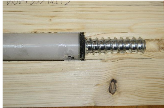
Figur V2-8: God tetting mellom gummipakning og bunn.
