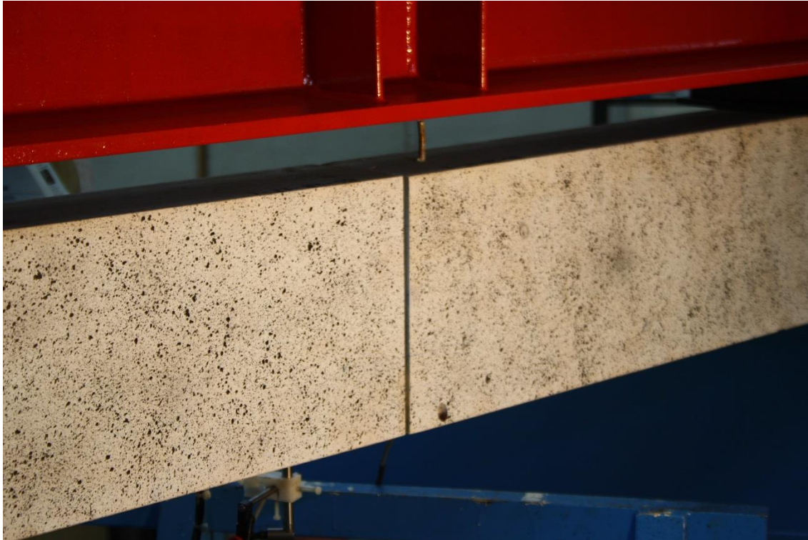
Figur V4-7: bjelken dekket i hvit spraymaling for å skape kontrast til de svarte prikkene som ARAMIS-skanneren bruker som målepunkter.
