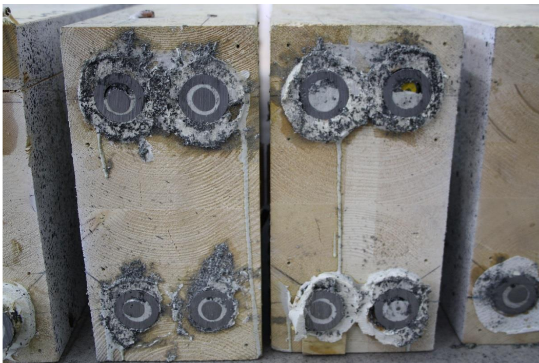
Figur 5-21: Hylsen opp til høyre og hylsen oppe til venstre er hver side av den samme hylsen. På hylsen oppe til høyre ser man godt at hylsen kun er halvfull med lim.
