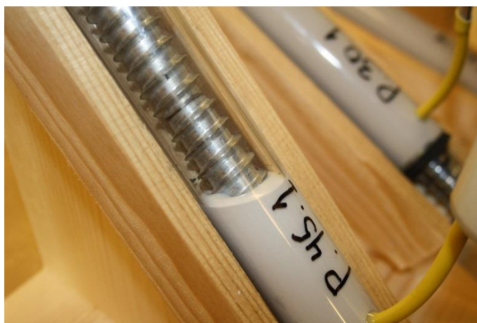
Figur 4-2: Gysing av lim i forsøk 1. Her kommer det tydelig frem at limet flyter godt gjennom hylsen da limet er jevnt fordelt vertikalt med en tilnærmet horisontal overflate på toppen av limet.
