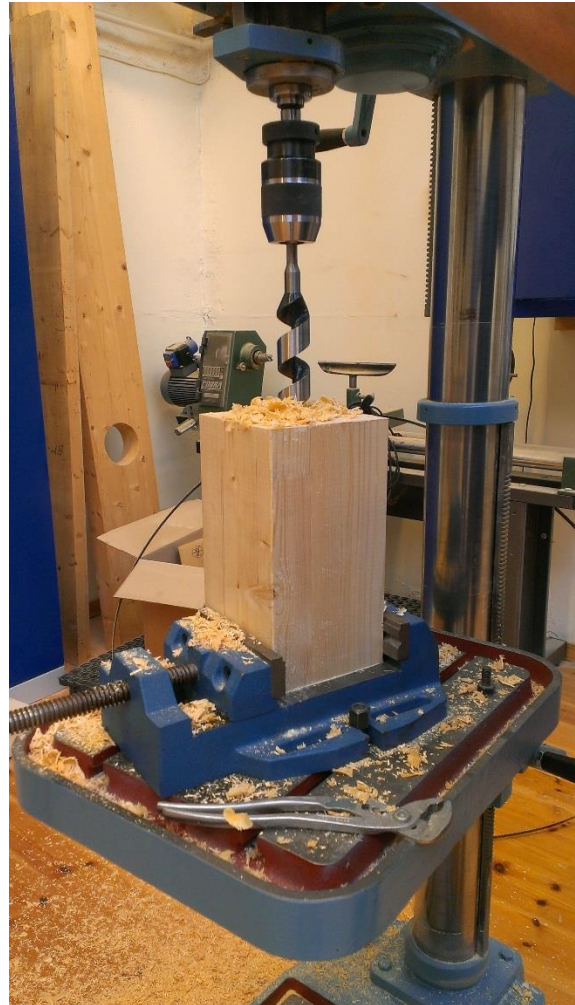
Figur VI-6: Forboring av hull for akrylhylse. Boringen ble utført med et 32mm bor i en borerigg der man fikk satt fast trestykket i skruestikka.
