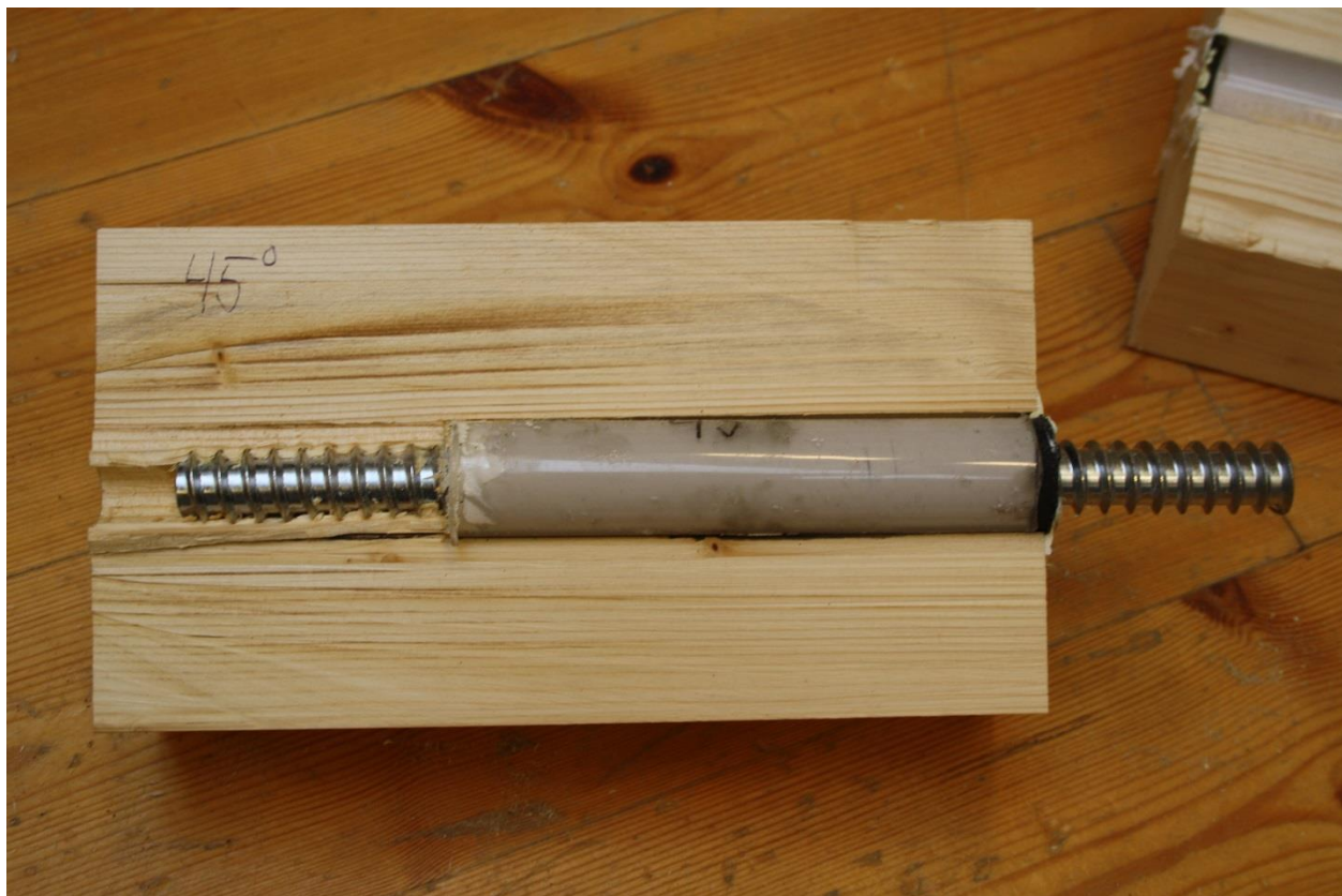
Figur V2-12: Dette eksemplaret viser faren ved å benytte silikonpakning i bunn, spesielt før den har tørket skikkelig. Her har pakningen blitt dratt inn i hylsen og blandet seg noe med limet, i tillegg til at det tar plass som skal sikre heft mellom skrue og hylse
