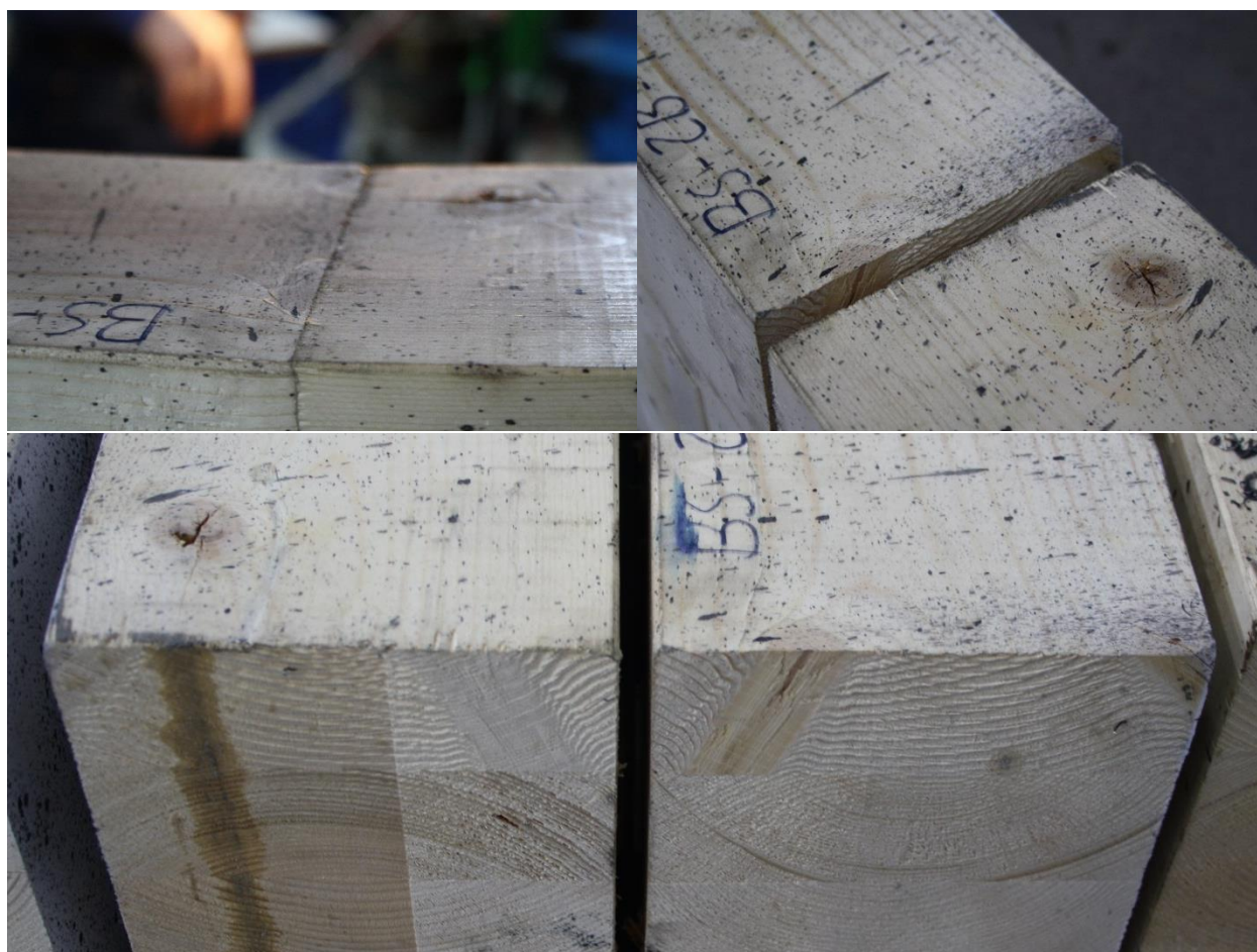
Figur 5-18: Øverst til venstre ser man hvordan bjelken har presset seg sammen mot hverandre i toppen. På bildet oppe til venstre og bildet nederst ser man mønstret som har dannet seg i kontaktflaten.
