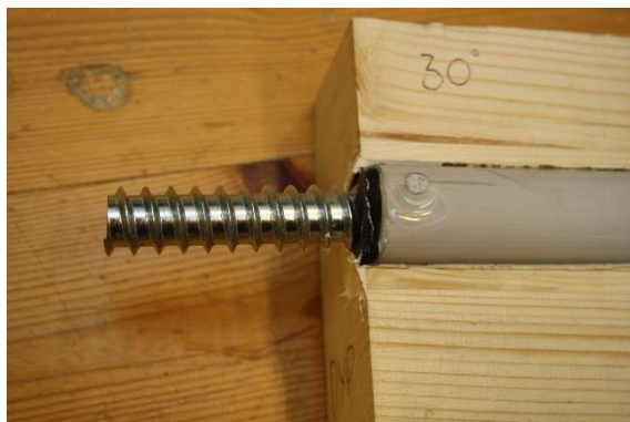
Figur V2-13: Hylsen viser ingen tegn til lekkasje. Også her ble gysehullene boret samtidig som hullene i hylsa som sikrer perfekt treff. Her ble det i tillegg brukt silikon på enden av hylsa i ytterkant for å sikre at evt. lekkasje ikke rant ut gjennom hullet.
