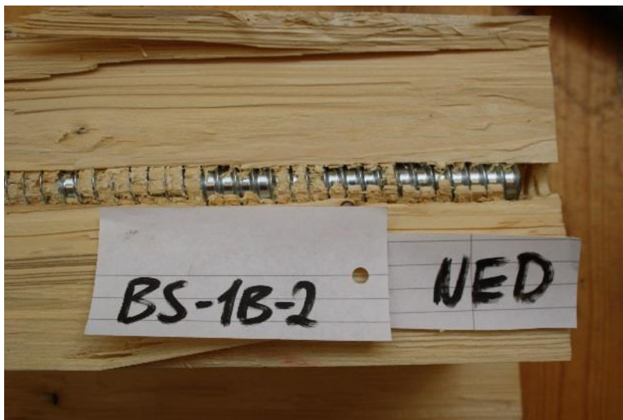
Figur 5-15: Her vises tydelig uttrekk av gjengestaget fra treverket.
