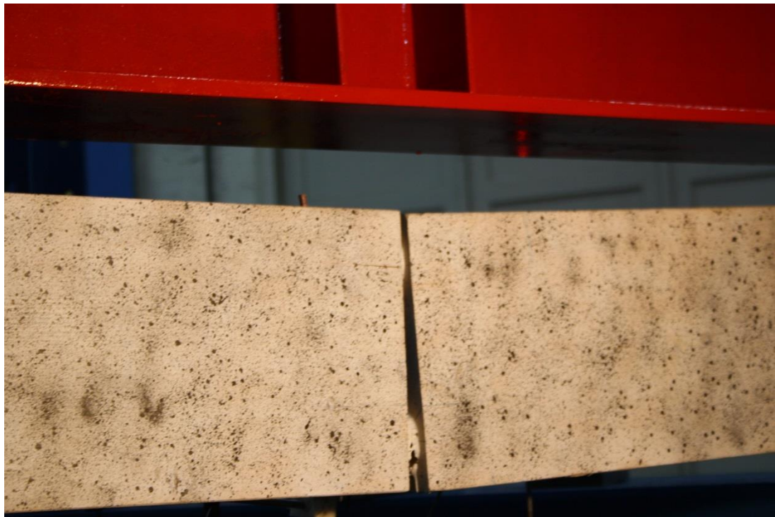
Figur V4-31: Rotasjon ved brudd. Oppsprekking i fibre langs gjengestag i topp.
