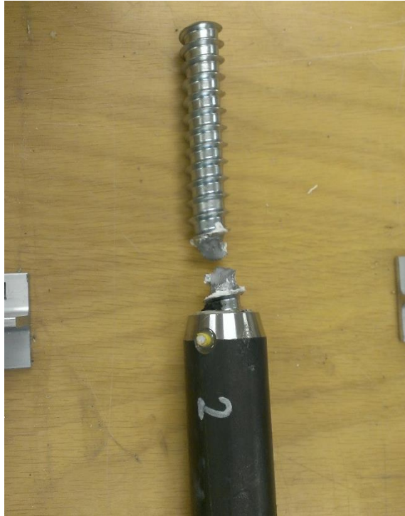
Figur V3-4: Brudd i skrue, test 5, hylse nr.2
