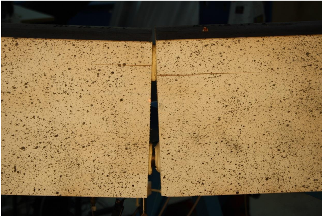
Figur V4-17: Store deformasjoner som følge av fortsatt på-lasting etter kraft tapet ved ca.55 kN. Sprekker i treverket rundt hylsen i topp.
