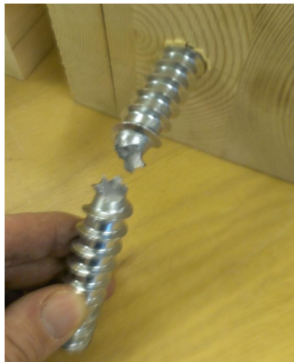
Figur V3-7: Brudd i skrue, test 3
