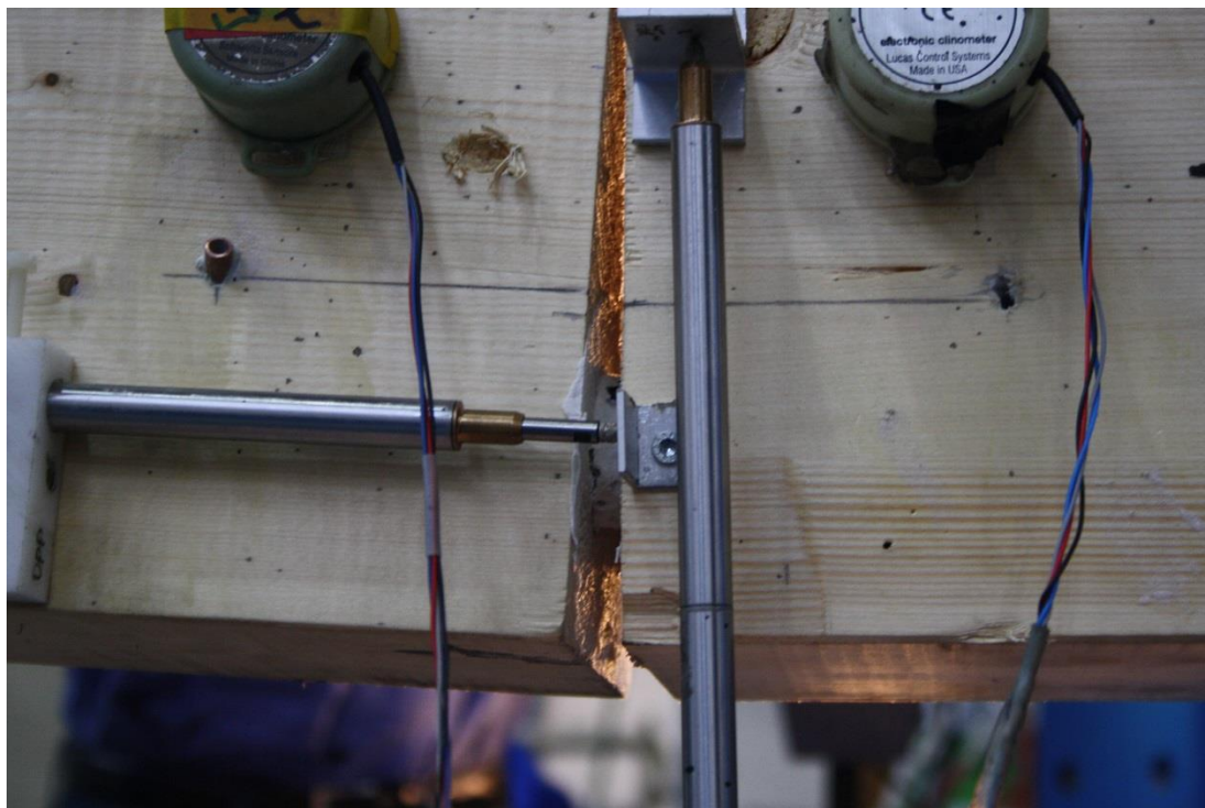
Figur V4-37: Størrelse på sprekken etter brudd.
