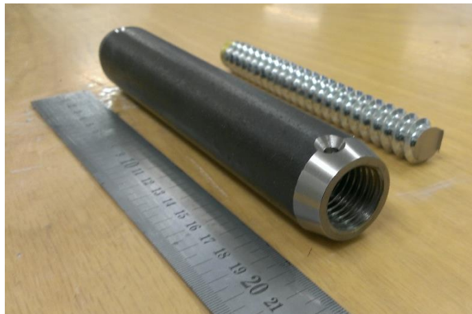
Figur 3-5: Ferdig produsert hylse sammen med en kort bit av et SFS gjengestag.
