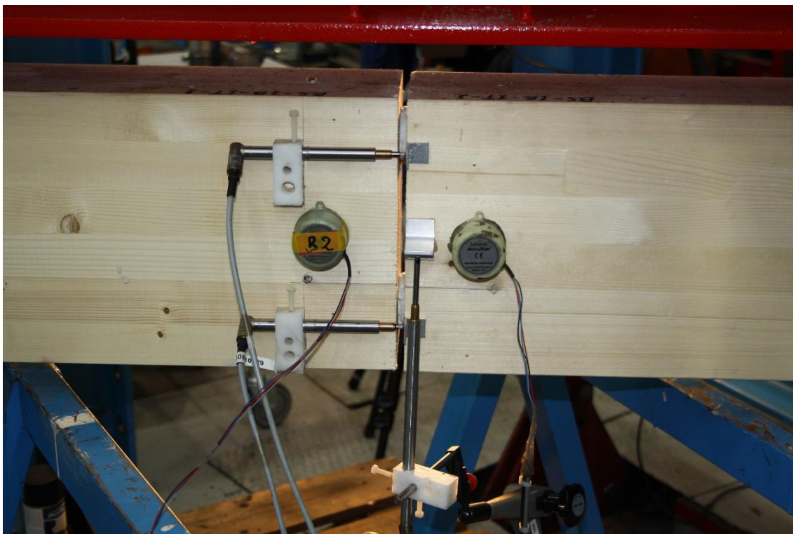
Figur V4-6: Oppsett av målere. Horisontal forskyvning i topp og bunn i samme høyde som skruene, vertikal forskyvningsmåler ved senter og en rotasjonsmåler på hver side av skjøten.
