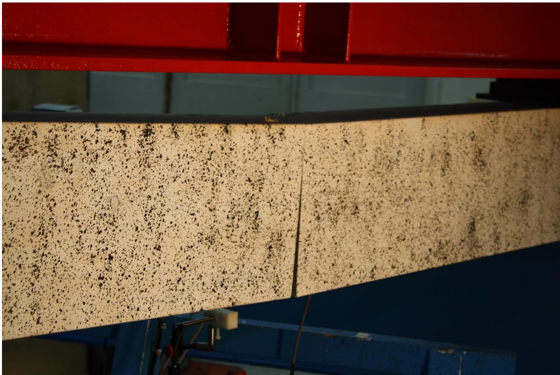
Figur V4-13: Stor deformasjon etter krafttap har inntruffet i på-loadingen.
