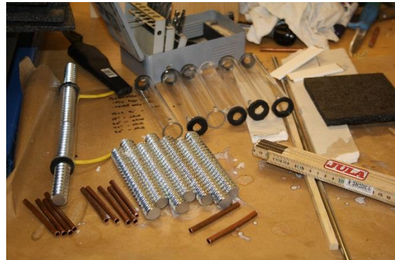
Figur VI-8: Enkeltkomponenter nødvendig for å lage prøvestykkene. På bildet vises skruer fra SFS Intec, akrylrør med gummipakninger og kobberør til gysing. Til venstre ligger en ferdig produsert prøvehylse for gysing.
