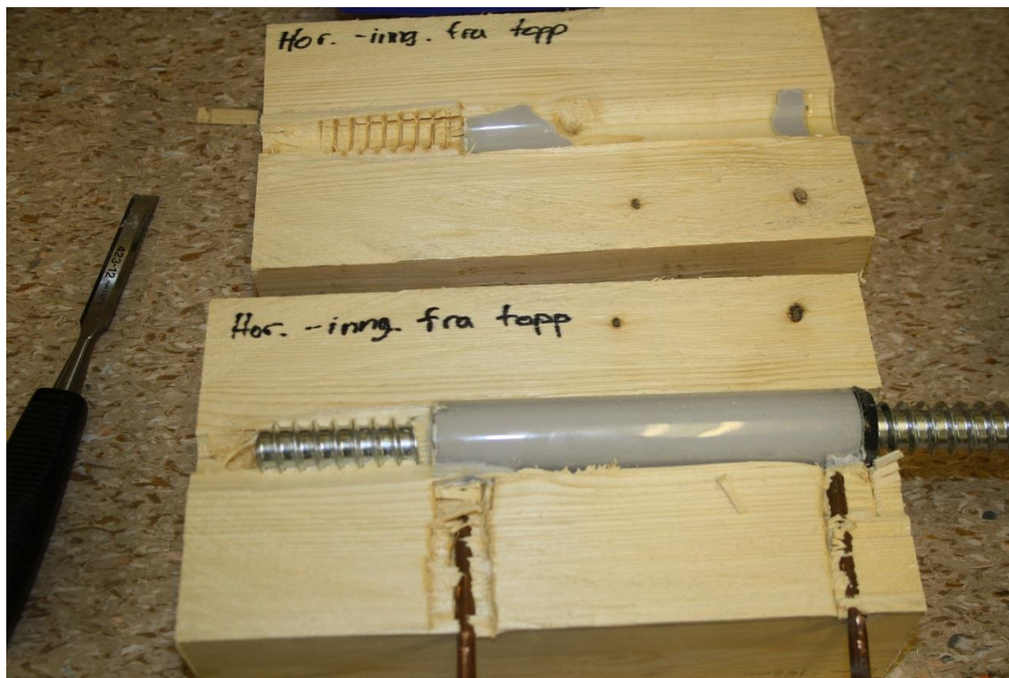
Figur 4-3: Her vises prøvestykket som ble gyst i horisontal posisjon etter at det er åpnet. Noe tegn til lekkasje utenfor hylsen. Pakning i topp var tett.
