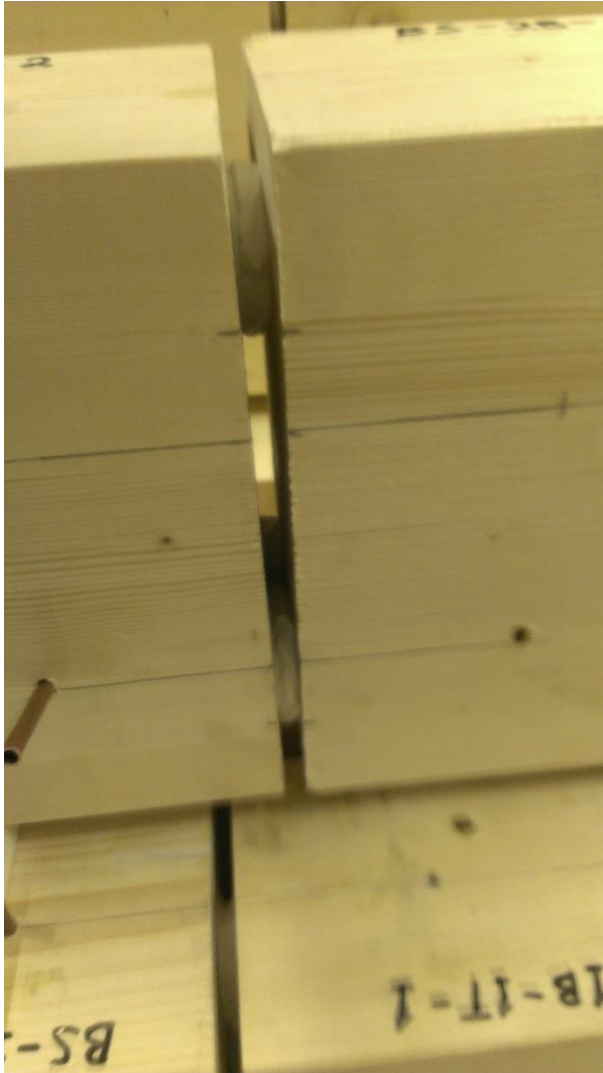
Figur VI -28: For bjelkeskjøtene som skal testes med skrue både oppe og nede ble de montert med 10mm opprom. Dette for å sikre at skruen i topp tar alt trykk. For å sikre gode tetting ble det lagt på rikelig med silikon rundt hylsen for endene ble ført sammen.
