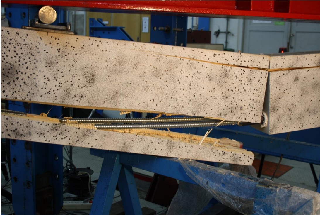
Figur V4-29: Etter betydelig opptak av moment, kollapset bjelken. I det den kollapset oppstod splitting langs gjengestagene. Tilsvarende de andre splittingene, men på grunn av skruer i begge ender av bjelkeenden kan dette ha forårsaket at splitten delte hele bjelken.
