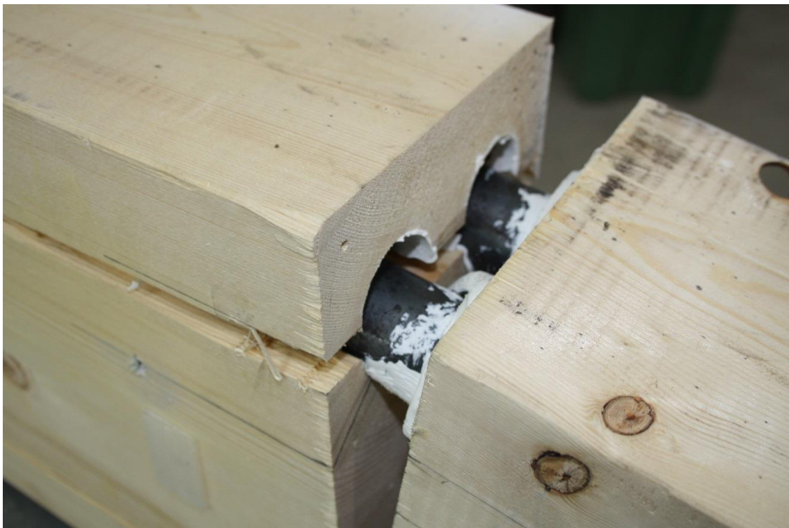
Figur V4-25: Bruddet sett fra undersiden.
