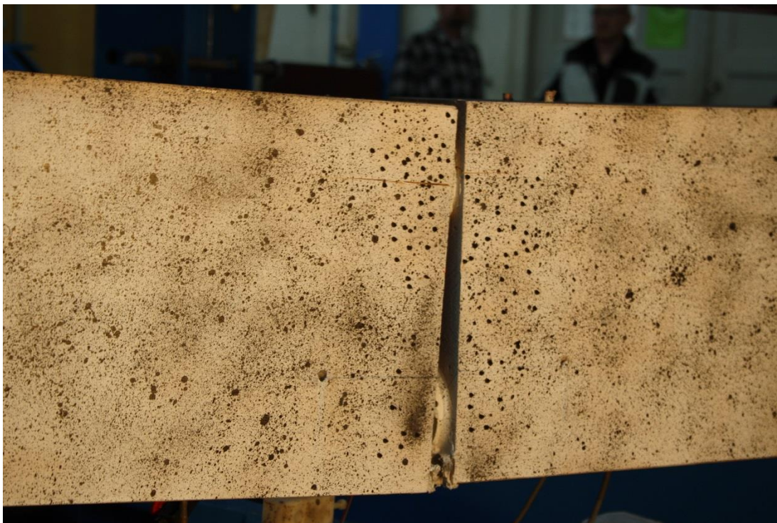
Figur V4-33: Sprekk langs fibre i topp i samme høyde som gjengestagene etter at brudd oppsto.
