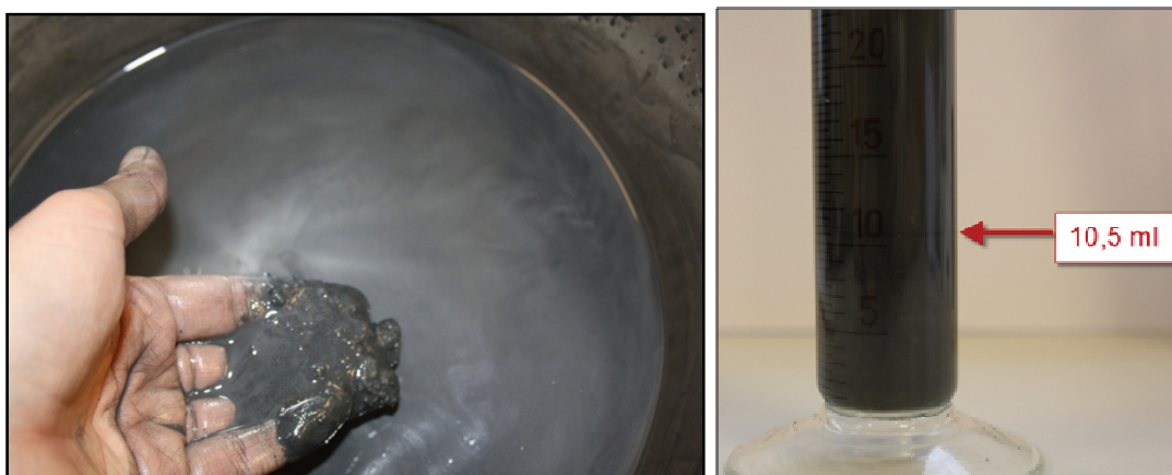
Figur 4-16: Oppløsning av Prøve L2866 i destillert vann under prøveprepareringen (venstre), og avlesning av skille mellom sedimenterte partikler og partikler i suspensjon (høyre).
