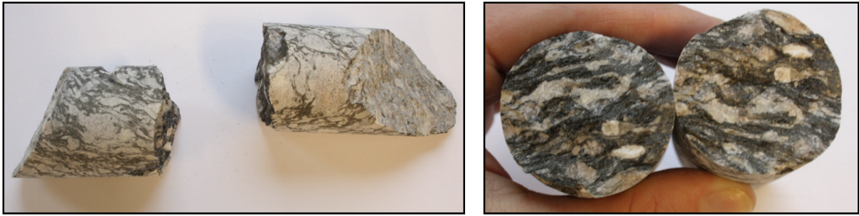
Figur 4-7: Kjernebiter etter punktlasttest. Til høyre de ferske bergartsflatene.
