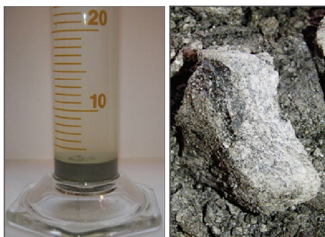
Figur 4-18: Fri svelling av 2 ml materiale (venstre) og nærbilde av biotittholdig bergartsfragment (høyre).
