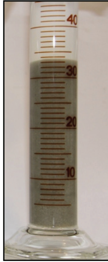
Figur 12: Resultat av fri svelling for prøve L3528-3.
