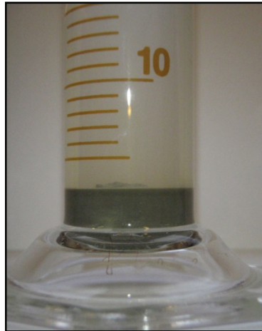
Figur 4: Resultat av fri svelling for prøve L2925.
