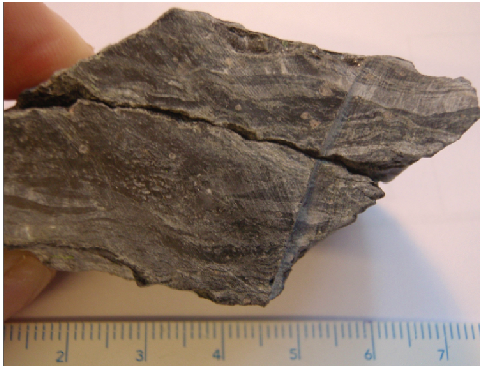
Figur 4-4: Kuttet kjerne. Her ser man tydelig lysere bånd, trolig av kvarts- og feltspatisk materiale, samt granater.
