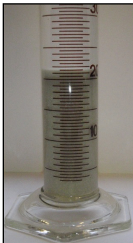
Figur 20: Resultat av fri svelling for prøve L4390-2.
