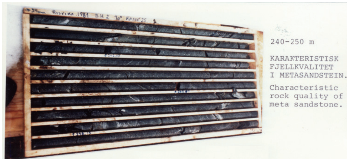
Figur 1: Kjerneborhull fra drivingen av Statpipe-tunnelene. Bergarten er karakteristisk fjellkvalitet i metasandsteinsonen i Karmsundet (Statoil, 1981).
