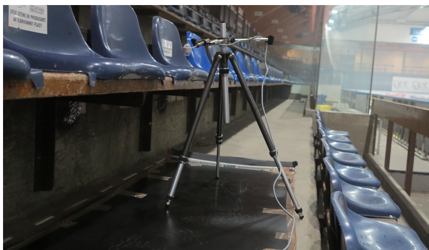
FIGUR 8.11: Slik ble måleproben posisjonert for å måle varmestrålingen på undersiden av låret, 50 cm fra den varme overflaten.
