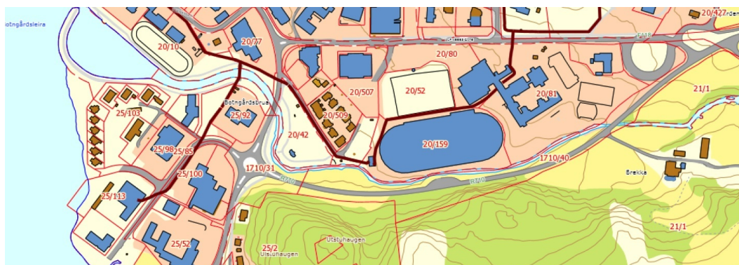
FIGUR 5.1: Kartutsnitt som viser distribusjon av fjernvarme i Bjugn. Varmepumpen står nederst til venstre i bildet, og Fosenhallen ligger i midten.
