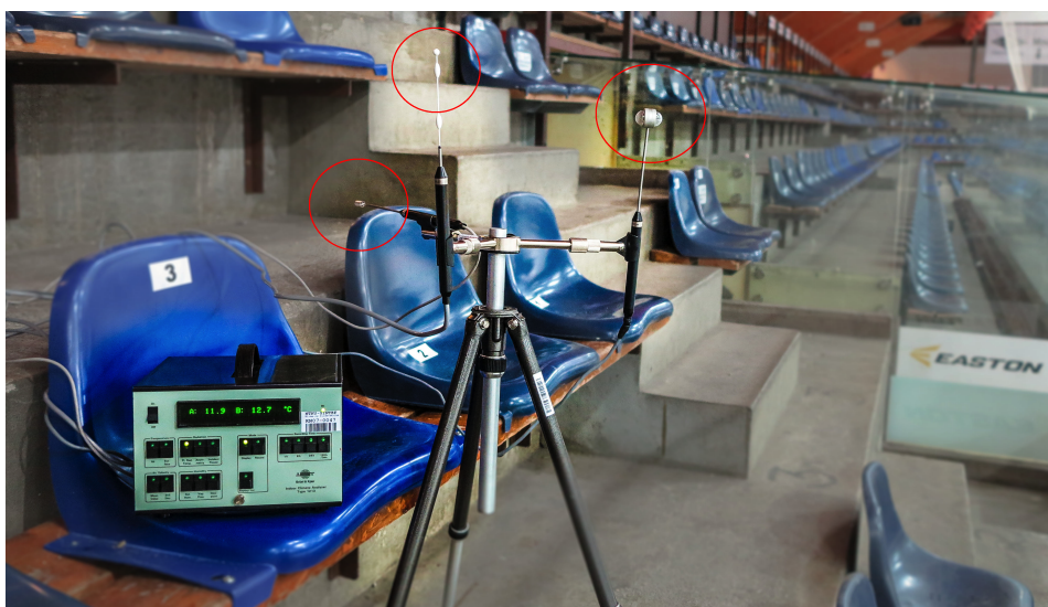
FIGUR 8.5: Måleoppsett for; middelstrålingstemperatur (proben mot høyre), lufthastighet (i midten) og lufttemperatur (til venstre). På bildet står oppsettet på andre rad.
