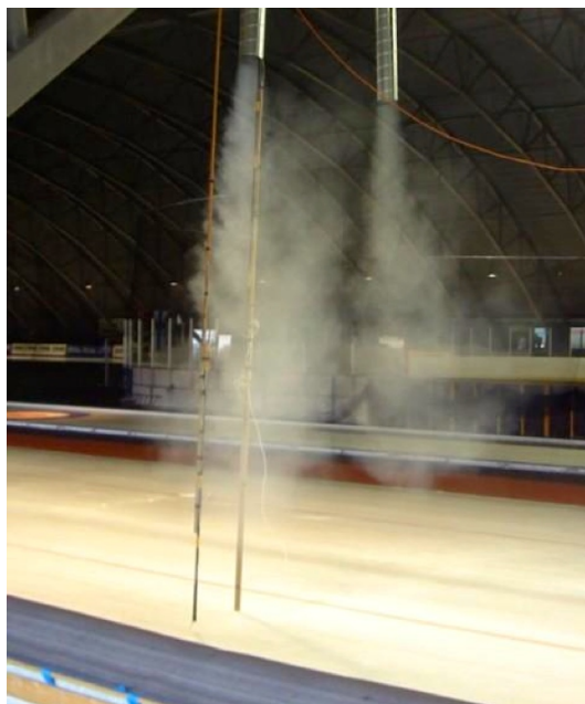
FIGUR 6.16: Illustrasjonbilde av teststriggen. Som vi ser på bildet oppnås nesten ønsket effekt, det mangler bare ca den siste meteren ned til isen.
