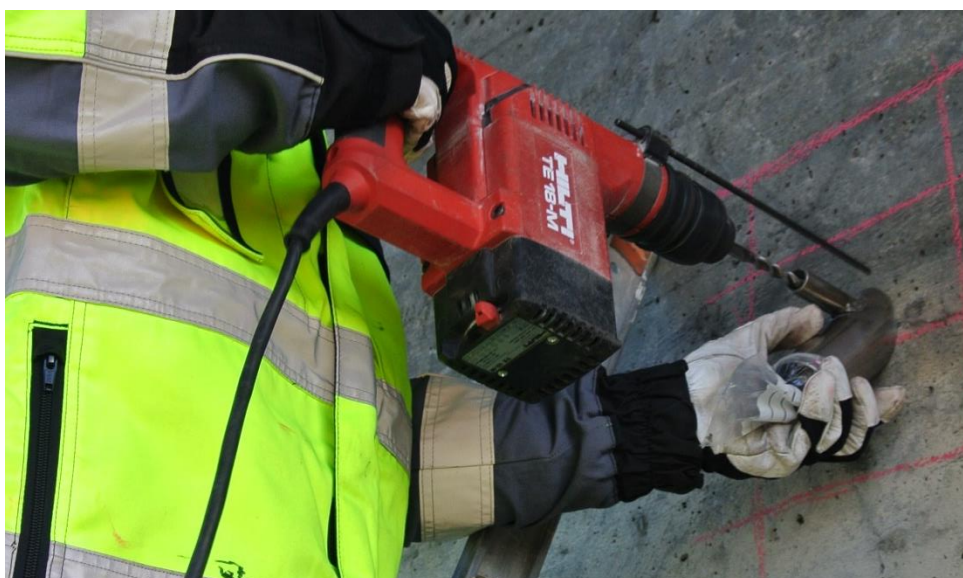
Figur 134: Kloridprøver samles inn i poser
