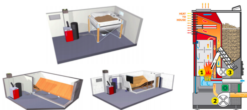
Figur 4.15: Til venstre: Eksempler på lagring av større mengder pellets med automatisk innmatning [75]. Til høyre: Forklaring av en pelletsovn: 1: Her blir pellets matet inn i fyren. 2: En vifte trekker frisk luft inn i forbrenningsrommet, og pumper eksosgasser ut av bygningen. 3: En konveksjonsvifte varmeveksler romluft og sender den ut i rommet, mateskruen avpasser foringen etter en termostat [83].
