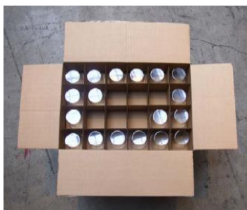
Figur 32: Brannscenario med esker med kopper (Schadenverhütung, 2011a)
