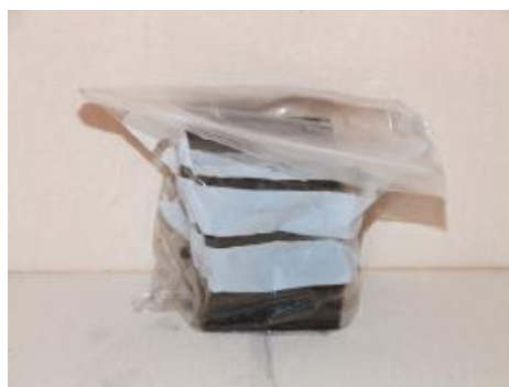
Figur 35: Fiberbord dynket i n-heptan i en plastpose (Schadenverhütung, 2011b)
