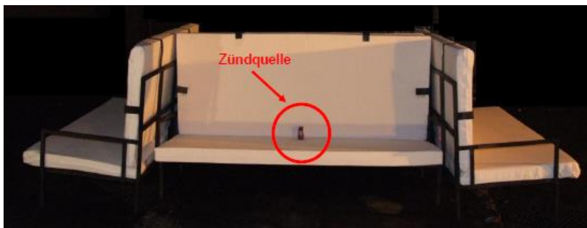
Figur 36: Bildet er tatt fra testen for hotellrom i VdS og her er antenneskilden «Fiberbord dynket i n-heptan i en plastpose» plassert i en av de fire sofaene i brannscenarioet. Denne er omkranset av en rød sirkel i figuren, hvor henholdsvis «Zündquelle» betyr «antenneskilde» på tysk (Schadenverhütung, 2011b)
