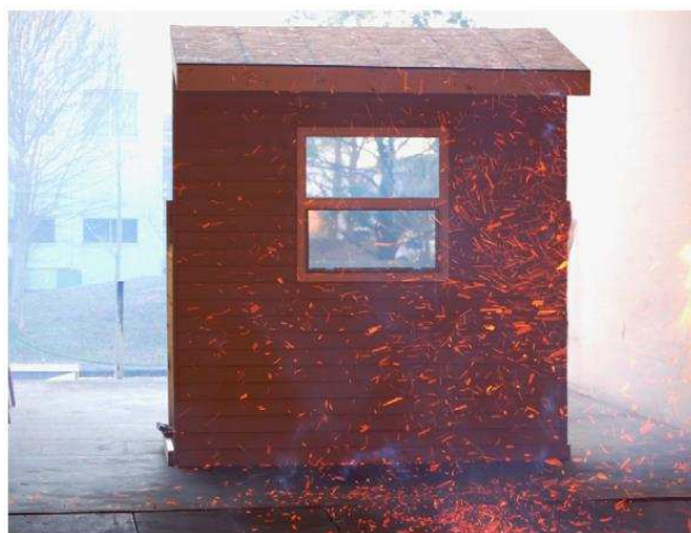
Figur 20: Vegg, åpen takfot og vindu utsatt for gnistregn [28]
