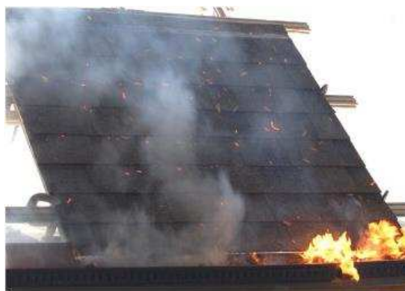
Figur 14: Antennelse i takrenne som følge av gnistregn [28]
