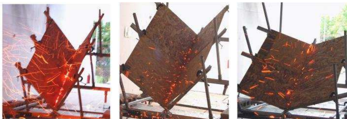
Figur 13: Takkonstruksjoner med vinkel, henholdsvis 60, 90 og 135 grader [28]
