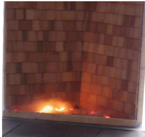
Figur 16: Figurene viser antennelse i barnåler og rusk foran konstruksjonen som videre antenner kledningene (vinyl til venstre og Cedar Shingle til høyre) [28]
