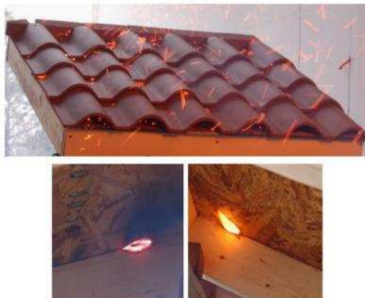
Figur 12: Takkonstruksjon utsatt for gnistregn, uten fuglebånd eller takpapp [28]
