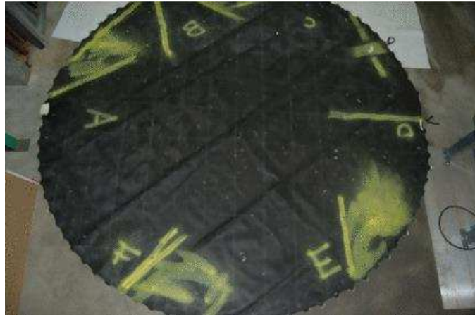
Figur 10: Trampolineduken som et av de viktigste funnen for å estimere påkjening av gnistregn
