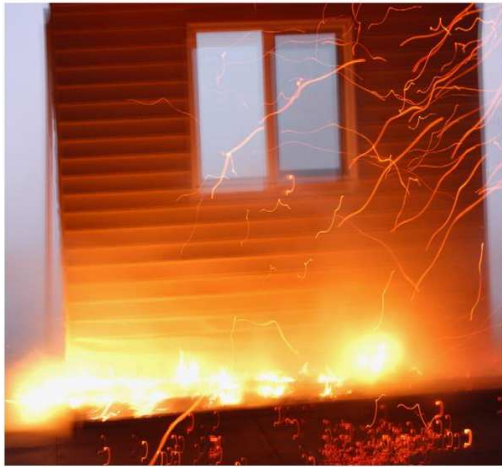
Figur 16: Figurene viser antennelse i barnåler og rusk foran konstruksjonen som videre antenner kledningene (vinyl til venstre og Cedar Shingle til høyre) [28]
