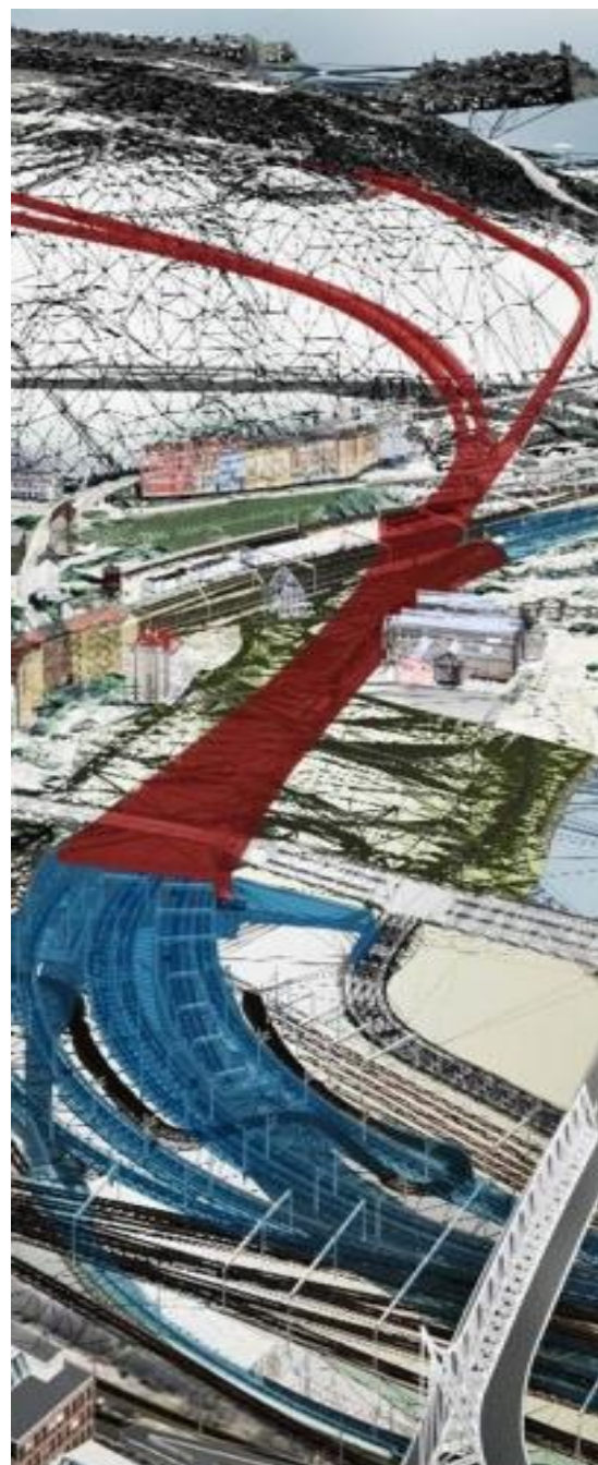
Figur 31 - Follobanen tunneler i Ekebergsåsen
