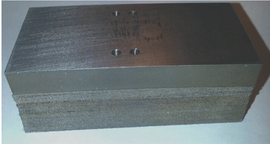
Figur 5.9 - Bilde av produsert komponent med 20 mm additivt påbygg med bunnsiden vendt opp
