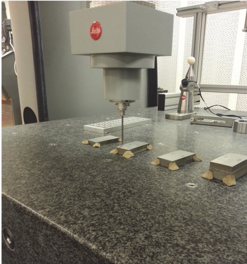
Figur 5.2 - Måling av prøver med Leitz PMM-C 600
