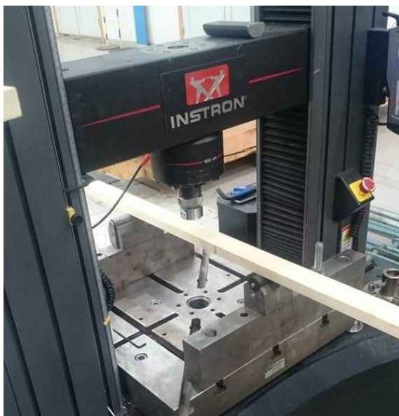
Figur 4.1: 3-punktsbøyning av prøvesegment
