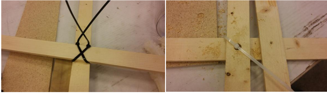
Figur 52: Alternativer til knutepunktløsninger, alternativ 1 til venstre og alternativ 2 til høyre
