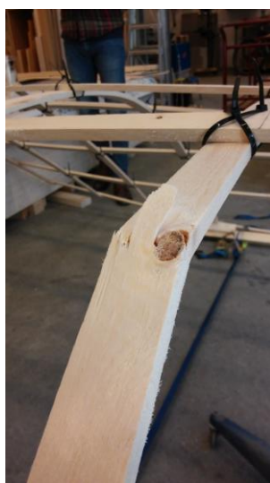
Figur 55: Kvist ble avgjørende for bjelkens bøyeegenskaper
