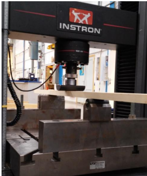
Figur 35: Bjelkene ble nedbøyd i midtpunktet med en jevn kraft
