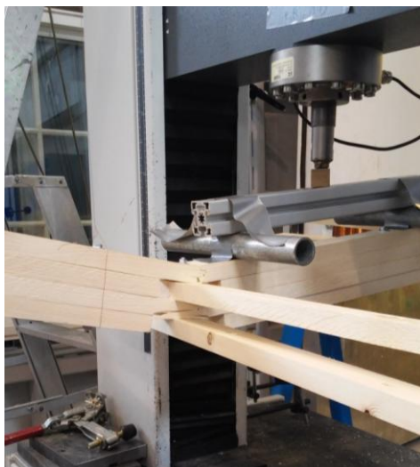
Figur 50: Bjelken med provisorisk fordeling av last. Brudd oppsto på samme sted i alle forsøkene
