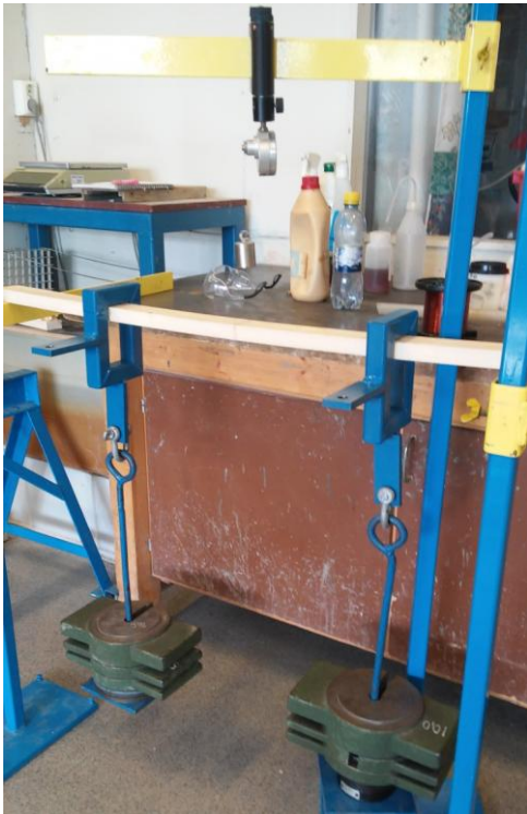
Figur 31: Vi utførte testen ved hjelp av to oppheng med vektskiver. Måleuret hang vi over bjelken, surret en ståltråd rundt spolen og knyttet den til bjelken. Vi var nøye med å nullstille måleuret før start og passe på at ståltråden hang vertikalt. Dette var derimot det mest ustabile ved gjennomføring av forsøket. Nødvendige avstander og dimensjoner er listet opp i tabell 2.
