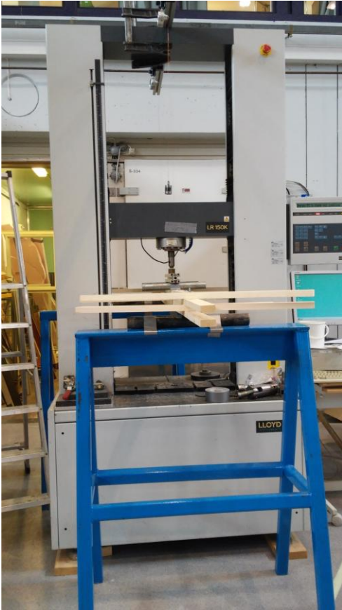
Figur 48: Segmentbjelketest hos Sintef
