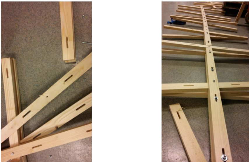
Figur 58: Bjelkesegmenter skåret til med fres, sortert i kryss og videre montert sammen med bolter med diameter 8 mm
