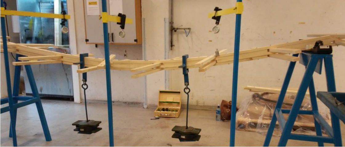
Figur 43: Segmentbjelke med påført last. Vi valgte å bruke tre måleure for å få en bedre oversikt over nedbøyningen dersom det skulle dukke opp lokale forskjeller i treverket
