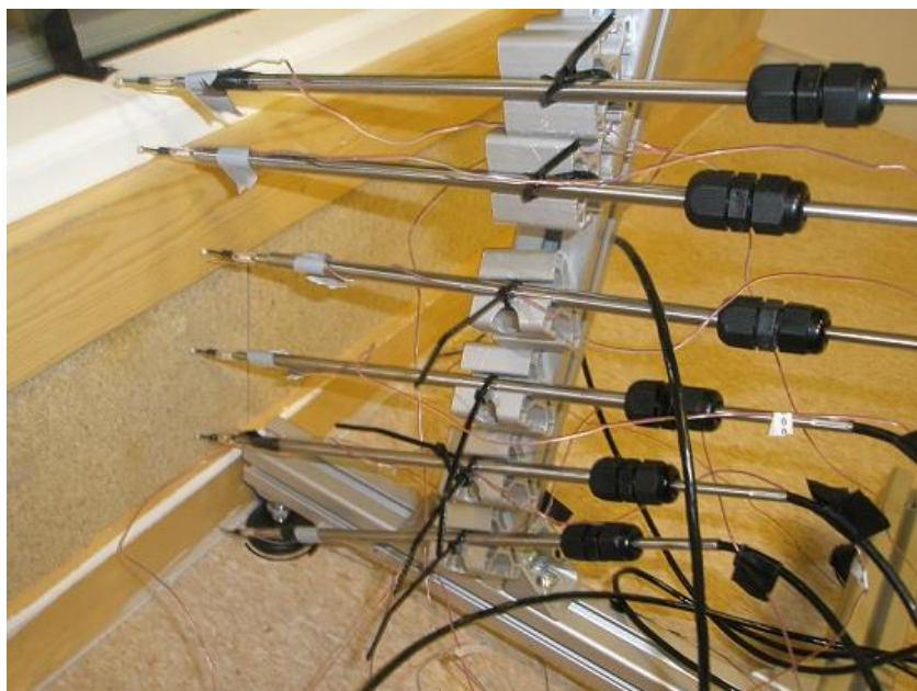
Figur 5.7 Måleoppsettet ved hastighet og temperaturmålinger over karmen og ned til gulvet
