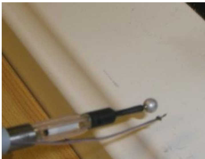
Figur 5.6 Plassering av termoelementene på hastighetsfølerne
