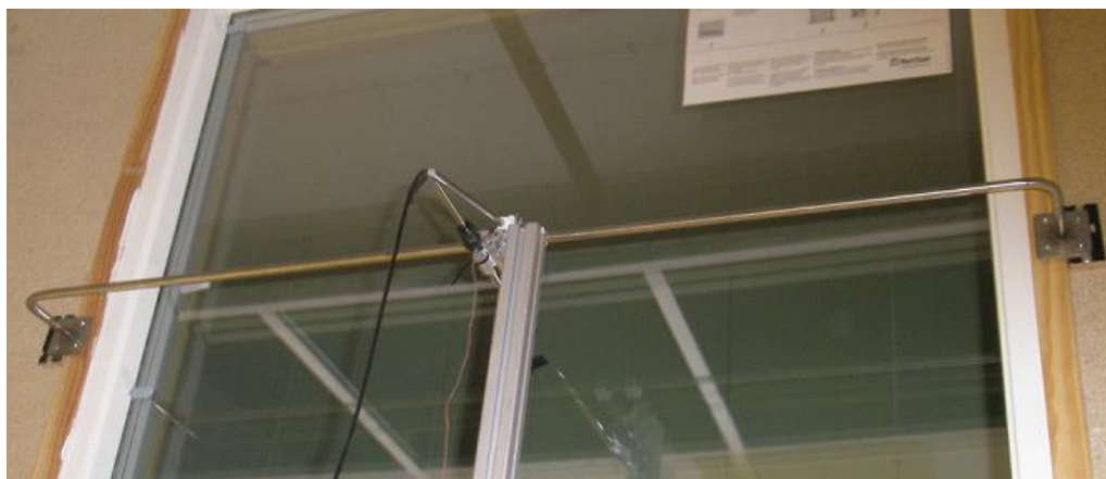
Figur 5.5 Tilleggsstativet som holdt stativet med hastighetsfølere stabilt
