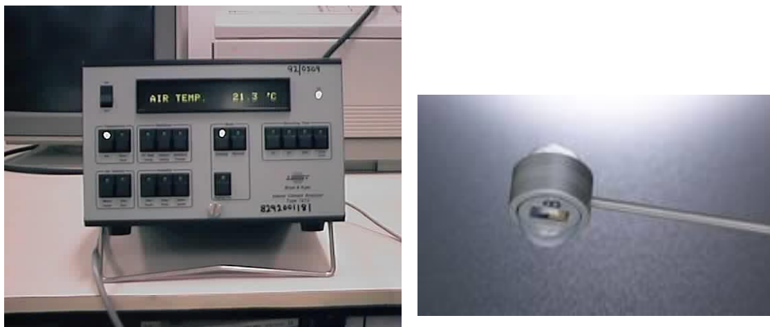
Figur 5.3 Avlesningsenheten til høyre og måleproben til venstre, brukes til måling av asymmetrisk stråling (National University of Singapore, u.d.), (LumaSense Technologies, 2013)
