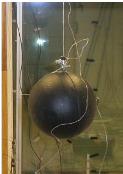
Figur 5.4 Den svarte kula som ble brukt til måling av romtemperatur
