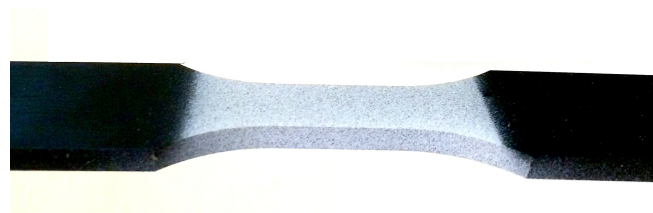
Figur 3.4: Belegget som ble sprøytet på prøvestykket
