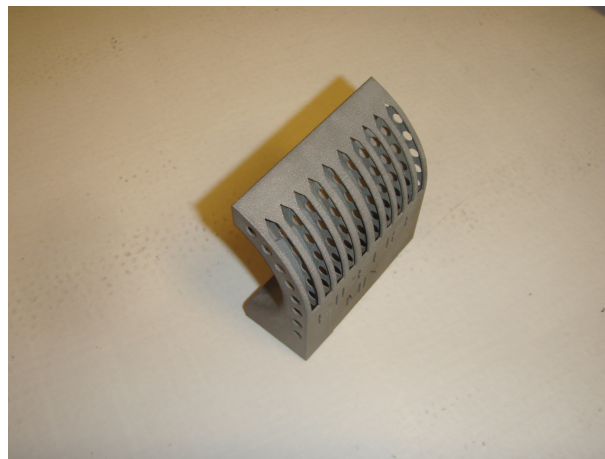
Figur 2.5: Eksempel på del som er lite egnet for tradisjonell produksjon
