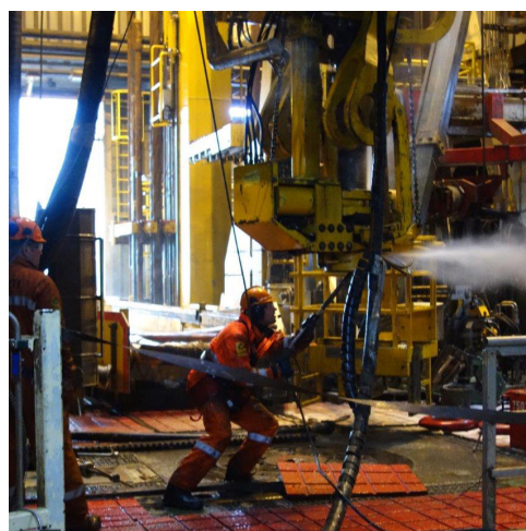
Høytrykksspyling av boreutstyr. foto: SINTEF
