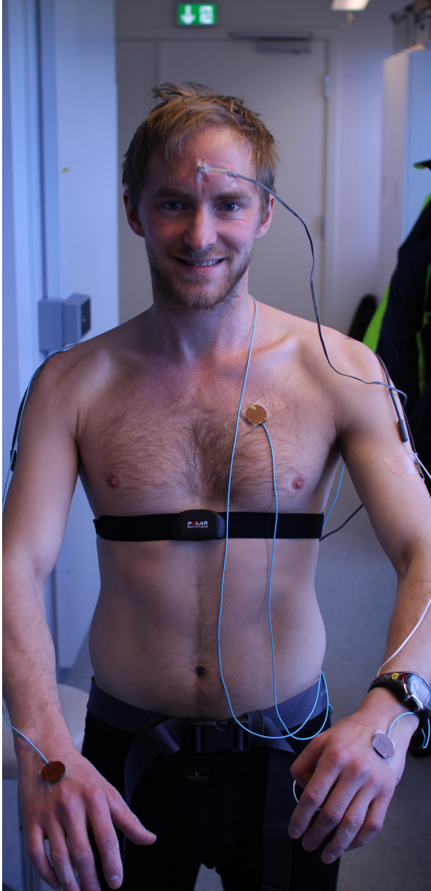
Puls, temperatur og temperaturflux måles med sensorer plassert på strategiske punkt på kroppen.
