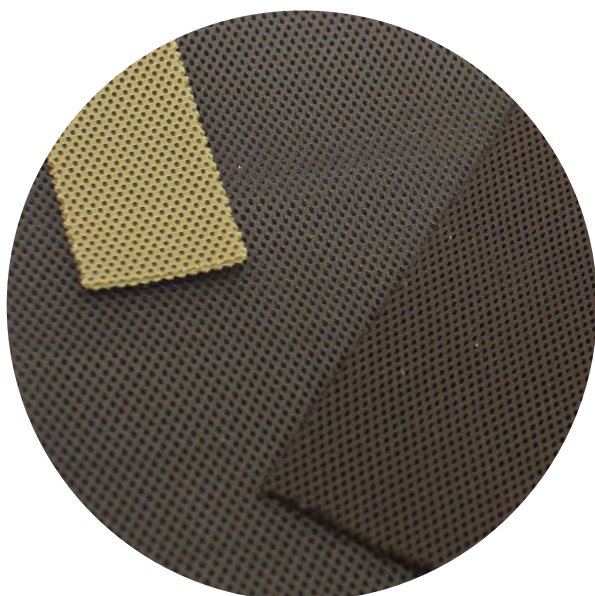
Spacerene finnes i mange varianter. Tykkelse, stivhet og frem og bakside kan variere mye.
