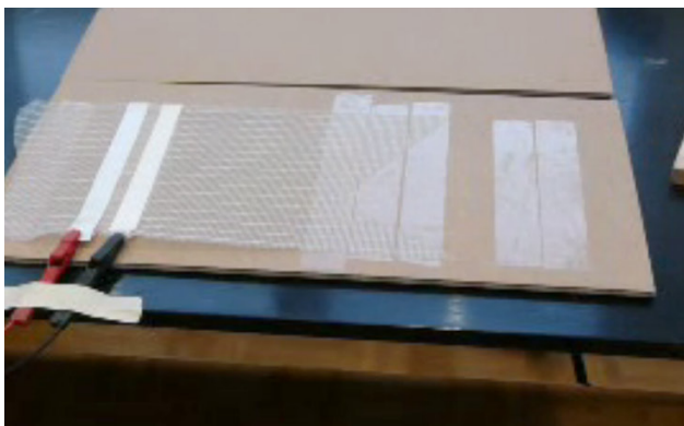
Demonstrasjon av varmeledende materiale som tåler kutting. Bilde: SEFAR
