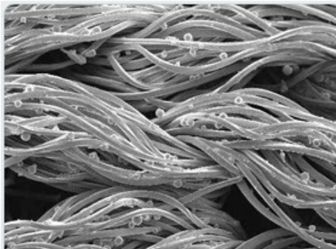
Polyester med kuler av parafinvoks. Bilde: Hangzhou Phase Change Technology Co.
