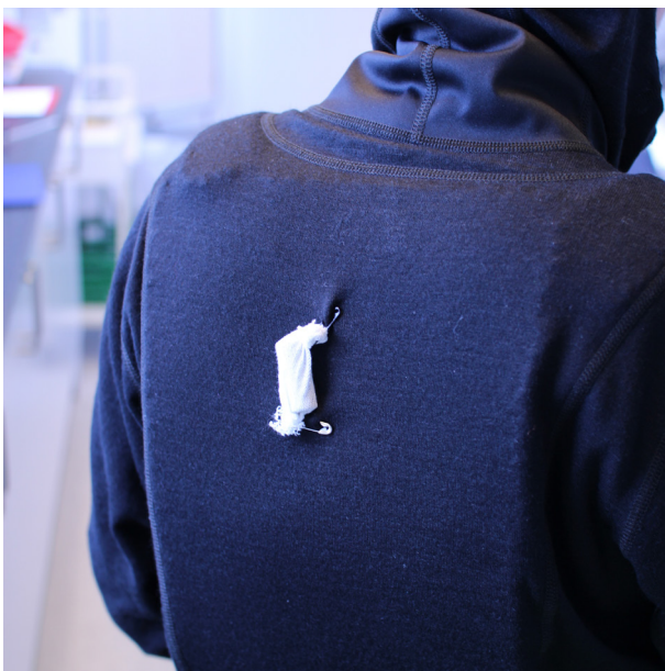
Sensorer plasseres mellom de forskjellige lagene, for å måle temperatur i klesplaggene
