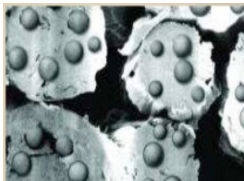
Polyester med parafin innkapslet under spinning. Bilde: Shamini Ganesh
