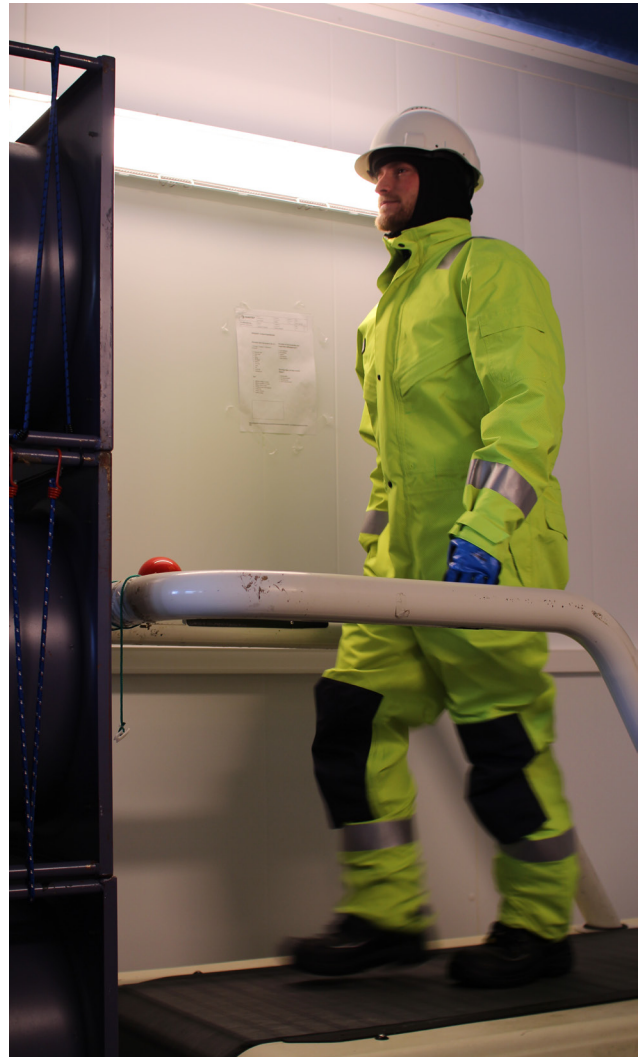
Testperson på tredemølle i kulderom, med mulighet for vind og stigning for å simulere ulike situasjoner.
