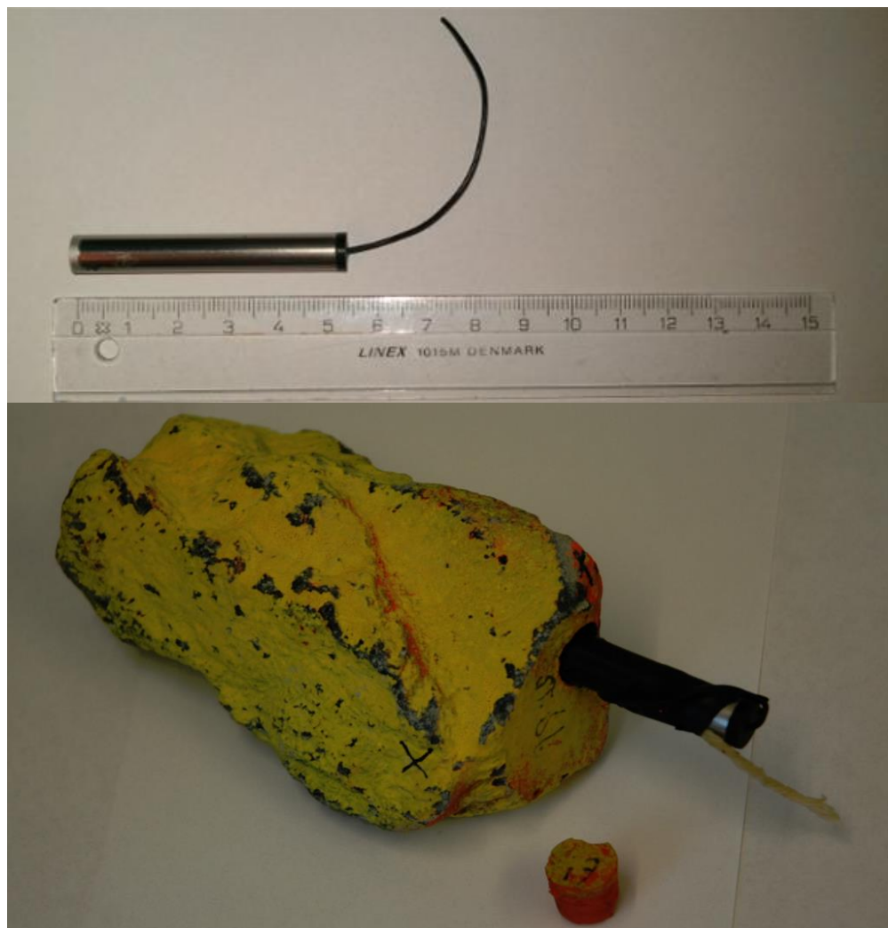
Figur 11: Øverste bilde viser Smartstone sylindren. Nederste bilde viser Smartstonesylindren plassert i et utboret hull i en plastringsstein. Sammen utgjør disse to komponentene en Smartstone. For å holde vannet ute ble steinen forseglet med en gummikork. Krysset som er merket av ble brukt under punktinnmålingene.
