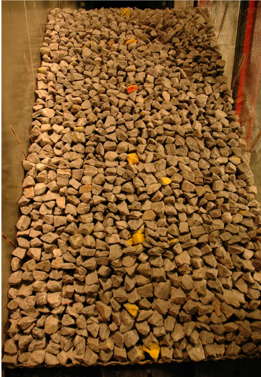
Figur 17: Plastret steinsikring uten forband. Fra forsøk nr.5.
