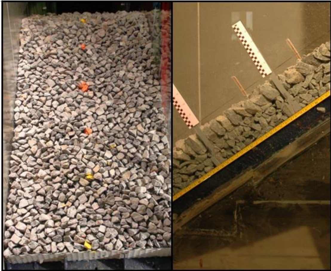
Figur 15: Plastring med forband. Bildet til venstre viser plastringen sett oven ifra, bildet til høyre viser et utsnitt av plastringen sett fra siden. Fra forsøk nr.2
