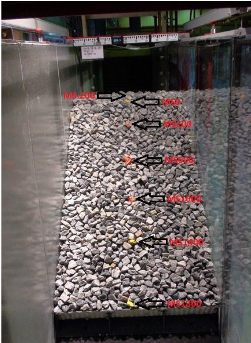
Figur 10: Oversikt over plastringen og de merkede steinene (MS) som ble brukt til punkttinnmåling. Fra forsøk 2.
