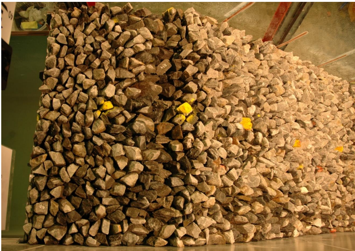
Figur 21: Kroma til plastringen etter en hydraulisk belastning, sett oven ifra (forsøk 3).
