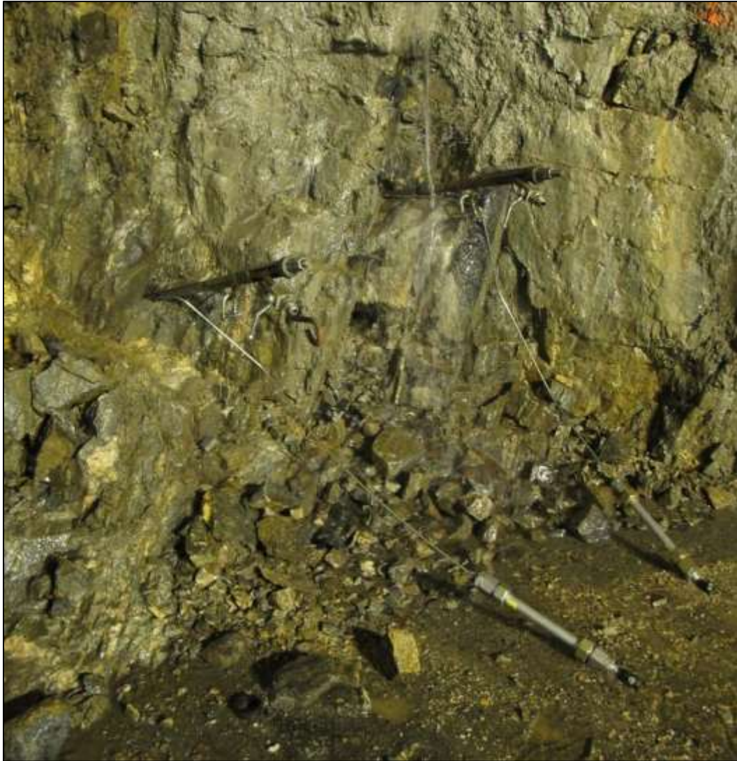
Figur 4.15 Loggerenheter som registrerte trykkutviklingen inne i borehullene ved hjelp av \frac{1}{4} rør gjennom sliss i pakkerne (Tunbridge, m. fl., 2014).
