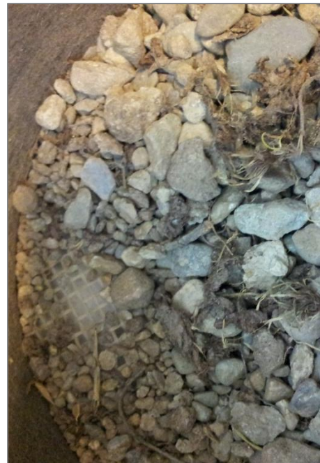
Bilde 4.4. 2mm sikt brukt ved preparering av prøvene med overflødig grus, sand og organisk materiale (Foto: Inga Marie D. Moe).
