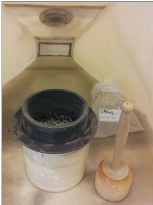
Bilde 4.5. Utstyr brukt ved sikting av prøvene. Sikt, morter og avlukke med avsug (Foto: Inga Marie D. Moe).
