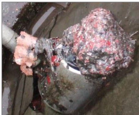
Bilde 3.3. Materiale samlet ved prøvetaking av sandfangskum (røde malingsflak samt olje var å finne) (Ottesen, 2013b, s. 38).
