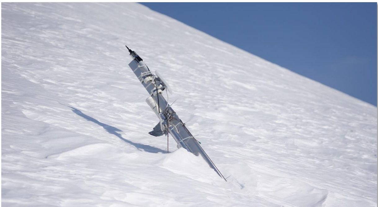
Figur 5.44 - Øverste del SM4-instrumentet har blitt bøyed fra midtre bardunfeste omtrent ved sensoren på 160 cm. Hølningsmåling på masten viste at den var bøyed omtrent 32 grader innover. Dette gir intervall på 17 cm i stedet for 20 cm mellom sensorene fra 160 cm og oppover etter at masten bøyde seg (foto: Martin Venås, 17. mars 2015).
