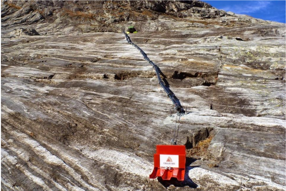
Figur 4.4 - En av glideskoene satt opp på Stavbrekka før vintersesongen 2013/2014 (foto: Cautus Geo, 15. oktober 2013)
