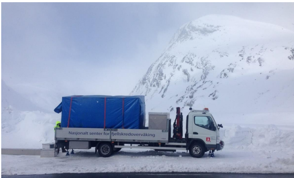
Figur 4.17 – Den bakkebaserte radaren er plassert på lasteplanet til lastebilen. Lastebilen står langs Rv. 15 omtrent 1,1 km i luftlinje fra startsonen på Stavbrekka (foto: Tore Humstad, SVV, 16. april 2015).
