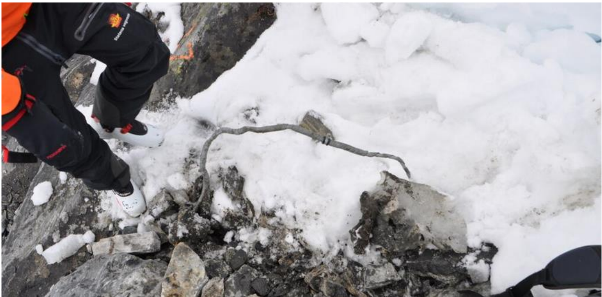
Figur 5.28 - Kabelen til glidesko 1 har blitt utsatt for store krefter også i forsøksåret 2014/2015 (foto: Tore Humstad, SVV, 7. mai 2015).
