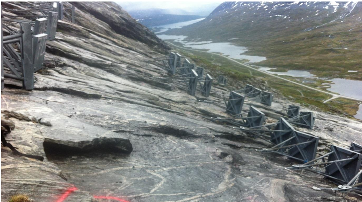
Figur 3.9 - Snøankerforsøk i glidesonen på Stavbrekka (foto: SVV, 25. juni 2013).
