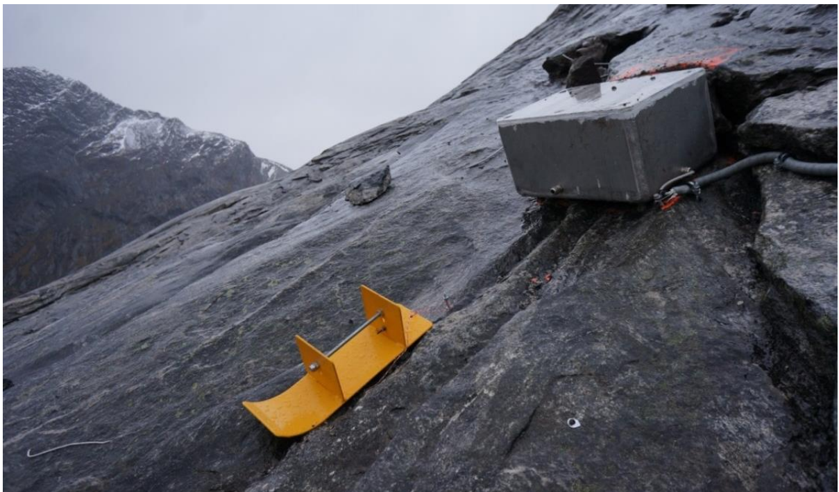
Figur 4.5 - Glidesko satt opp på Stavbrekka før vintersesongen 2014/2015. Glideskoene er festet til en posisjonssensor som ligger beskyttet i stålkassen (foto: Martin Venås, 23. oktober 2014).
