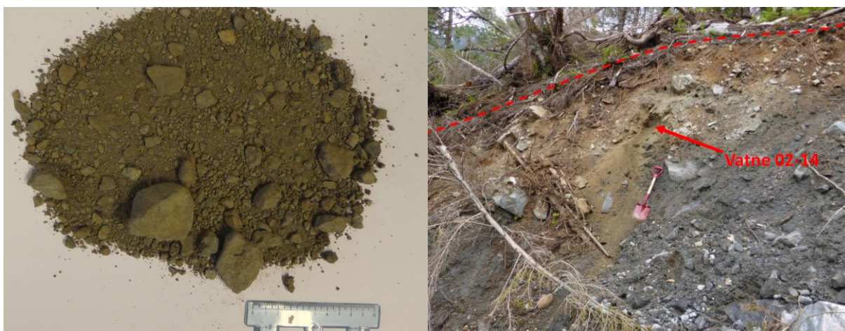
Figur 6.30: Figur til venstre viser Vatne 02-14 i tørket tilstand. Prøven Vatne 02-14 ble hentet fra ytterkanten på skredløpet. Foto: Gro Sandøy, NGU
