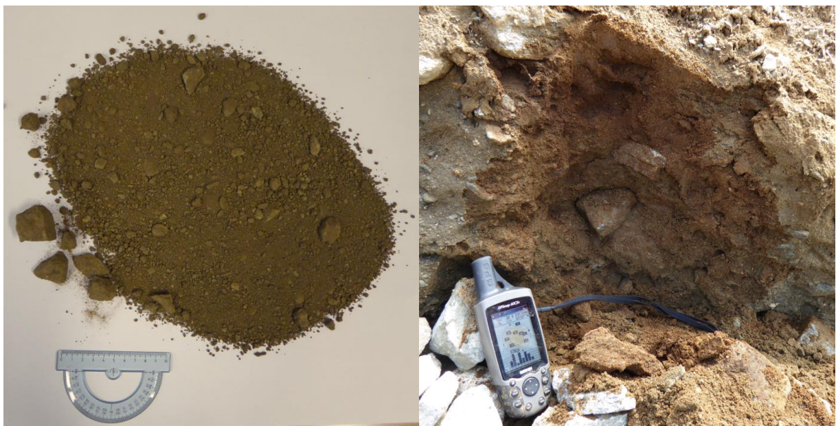
Figur 6.27: Figur til venstre viser Årset 03-14 i tørket tilstand. Prøven Årset 03-14 ble hentet fra glideplanet. Foto: Gro Sandøy, NGU
