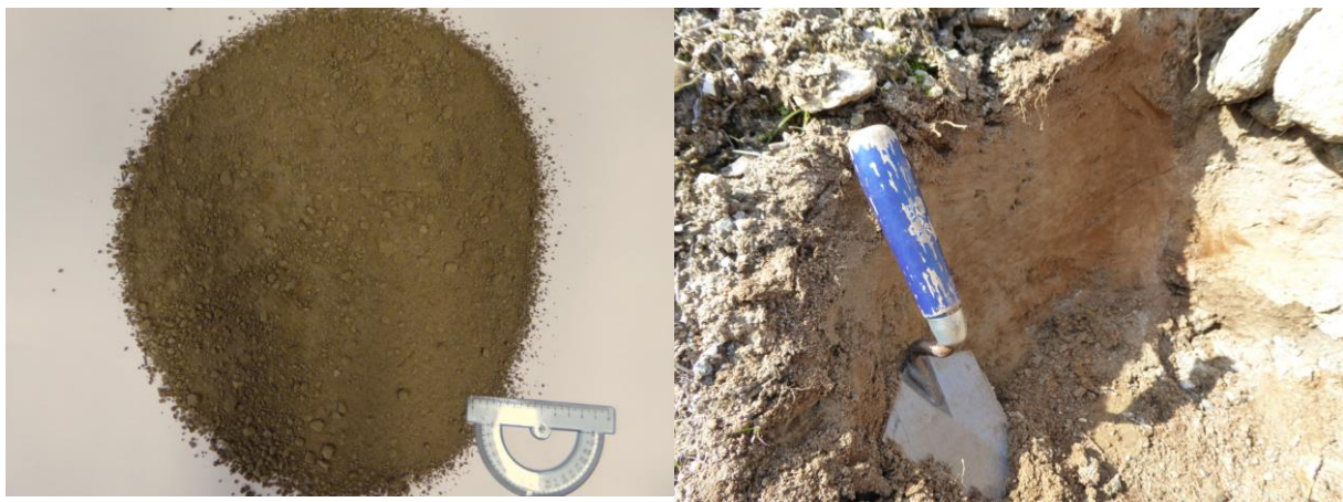
Figur 6.22: Figur til venstre viser Borga 04-14 i tørket tilstand. Prøven Borga 04-14 ble tatt i in-situmateriale. Foto: Gro Sandøy, NGU
