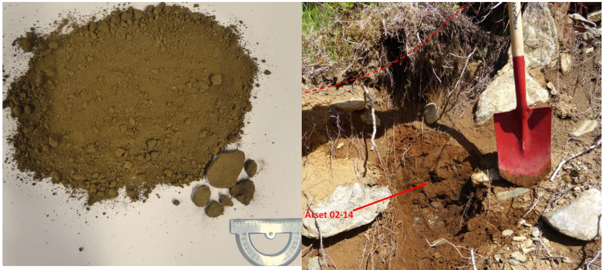
Figur 6.26: Figur til venstre viser Årset 02-14 i tørket tilstand. Årset 02-14 ble tatt i siden på skredløpet. Stiplet linje viser ytterkant på skredløpet. Rød pil viser plasseringen til prøven. Foto: Gro Sandøy, NGU
