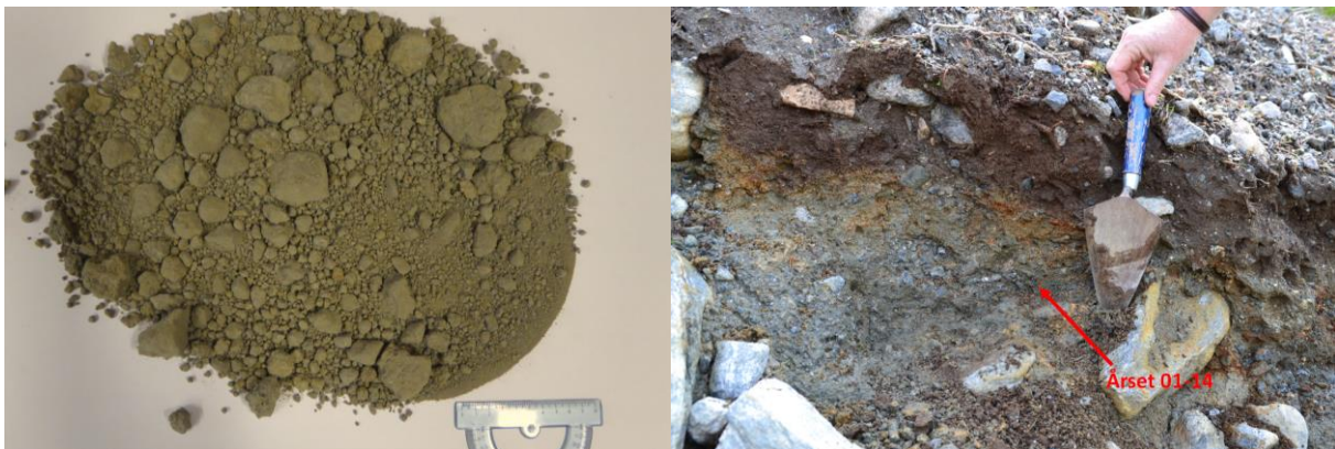
Figur 6.25: Figur til venstre viser Viromdalen 01-14 i tørket tilstand. Årset 01-14 ble tatt i bekk like nedenfor skadet hus. De øvre 10-20 cm er skredmateriale.
