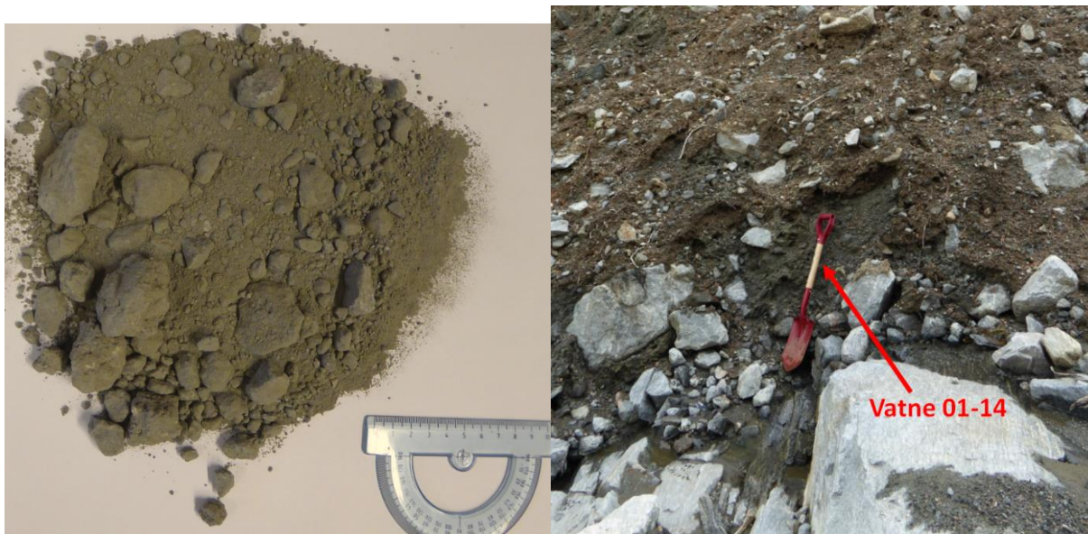
Figur 6.29: Figur til venstre viser Vatne 01-14 i tørket tilstand. Prøven vatne 01-14 ble tatt i det som under feltarbeid ble tolket til å være bunnmorene. Foto: Gro Sandøy, NGU
