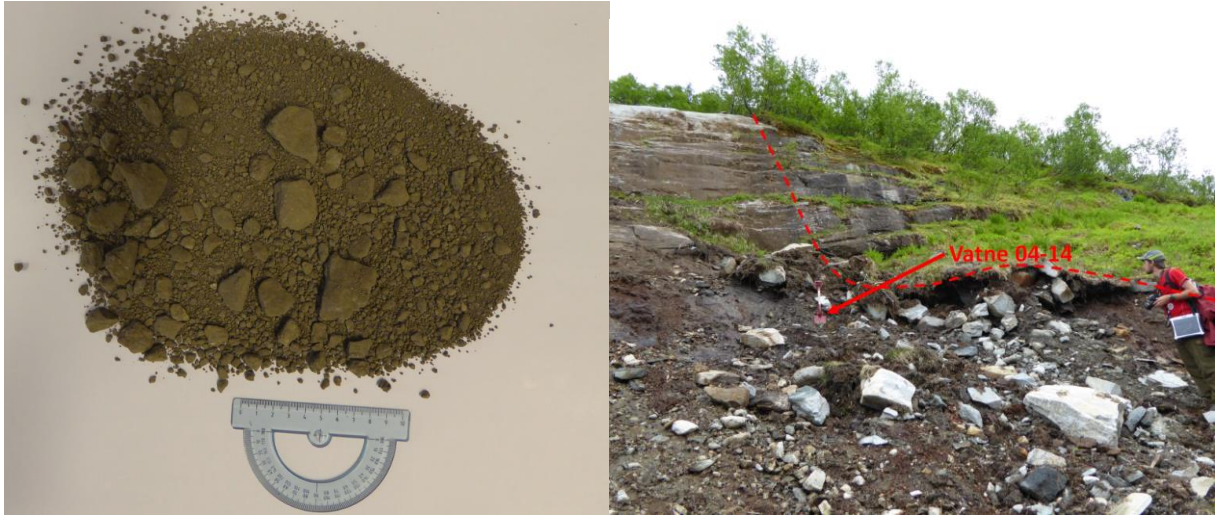
Figur 6.31: Figur til venstre viser Vatne 04-14 i tørket tilstand. Prøven Vatne 04-14 ble tatt i et sekundært løsnepunkt. Rød pil markerer plasseringen av prøven og stiplede linje markerer yttergrensen til skredet. Foto: Gro Sandøy, NGU
