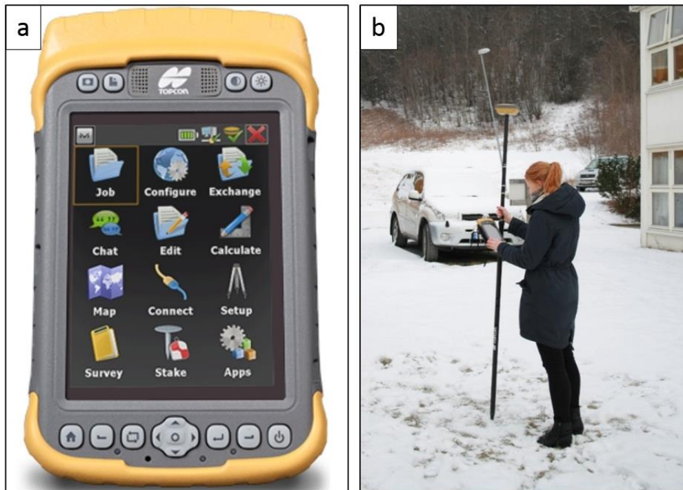
Figur 4.1 Nærbilde og oversiktsbilde av Tesla Topcon GPS. a) foto hentet fra Topcon Tesla RTK 2015), og b) foto av Marit J. Førde.
