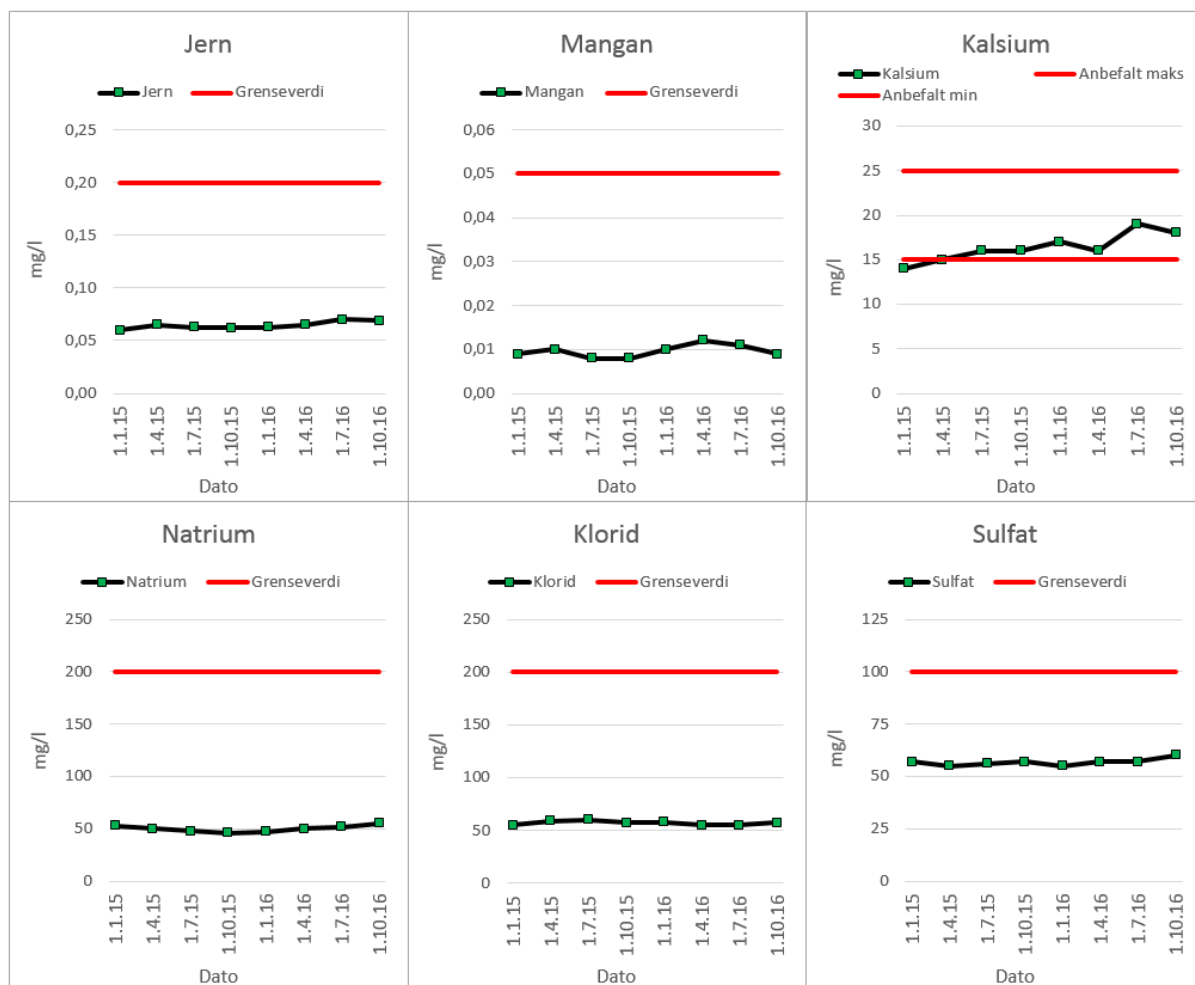
Figur 7.4 Eksempel på presentasjon av vannanalyser. Jern, mangan og kalsium fremmer utfellinger, mens natrium, klorid og sulfat fremmer korrosjon.
