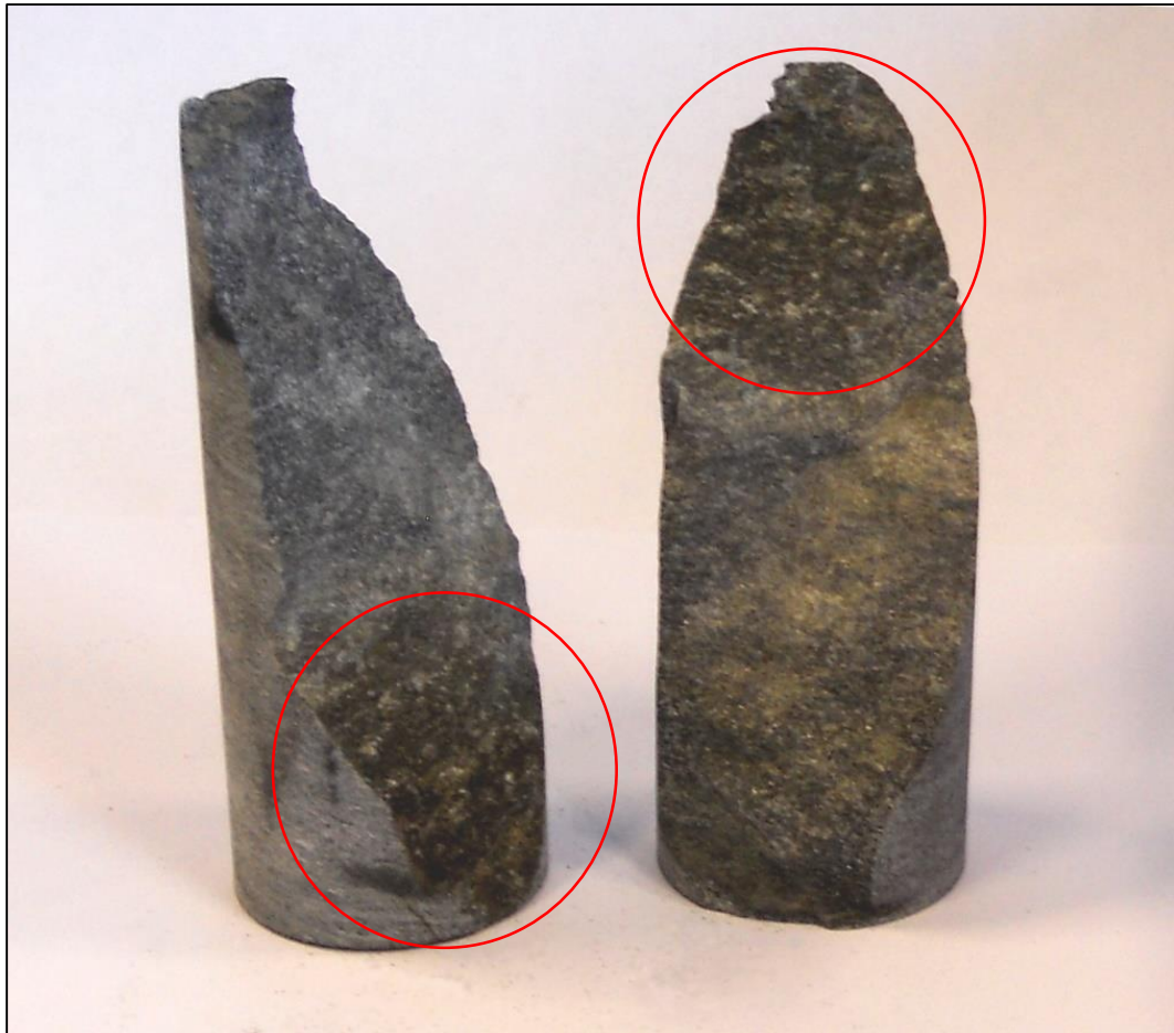
Figur 4.10 Forvittra område langs brotsona på prøve 2.1 (Foto: Lars Jørgen Hole).
