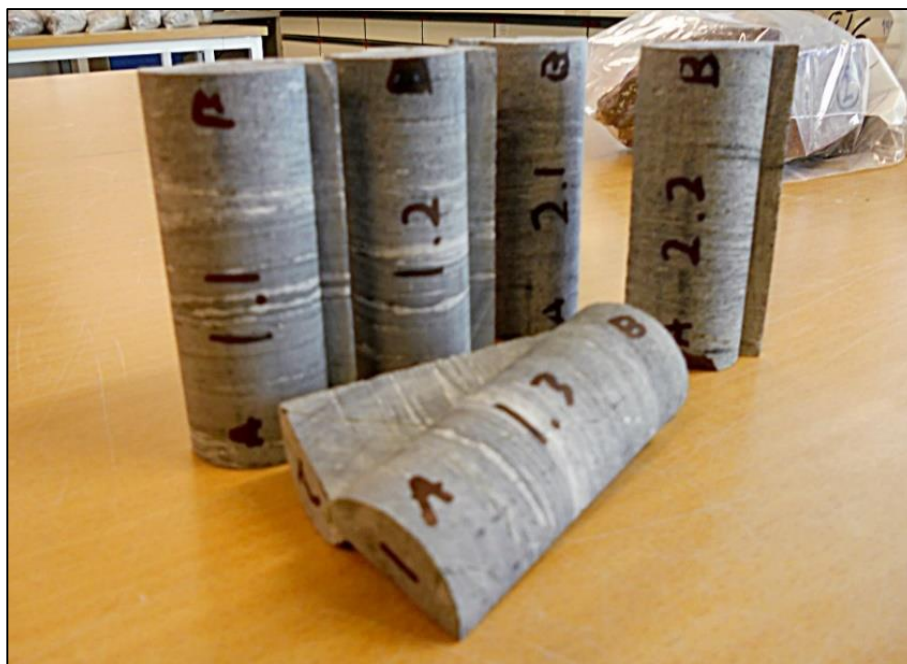
Figur 3.13 Prøver for tilt-forsøk (Foto: Lars Jørgen Hole).
