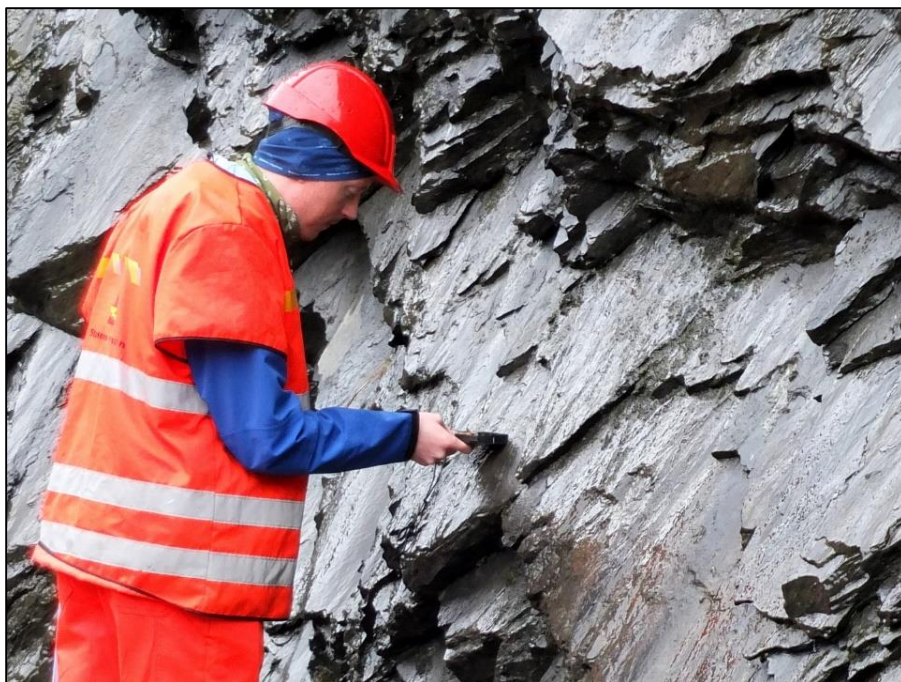
Figur 3.1 Måling av strøk og fall i felt (Foto: Gunne Håland).
