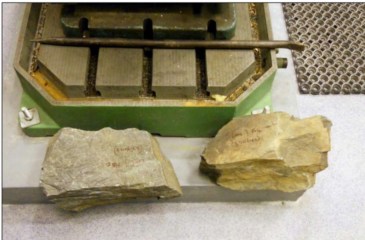
Figur 3.7 Blokkprøvene som blei tatt med frå feltområdet for laboratorieundersøking. Til venstre blokk 1 og til høgre blokk 2 (Foto: Lars Jørgen Hole).
