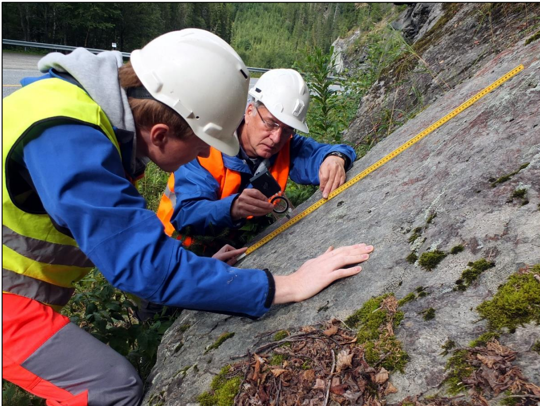
Figur 3.5 Måling av ruheit til sprekkeplan ved bruk av a/L metoden saman med rettleiar Bjørn Nilsen (Foto: Gunne Håland).
