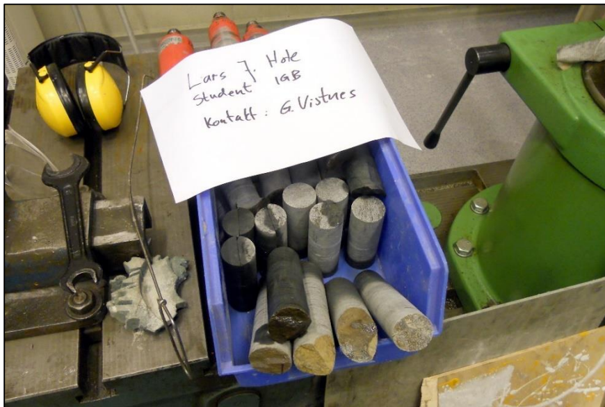
Figur 3.9 Ferdig bora kjerneprøver (Foto: Lars Jørgen Hole).
