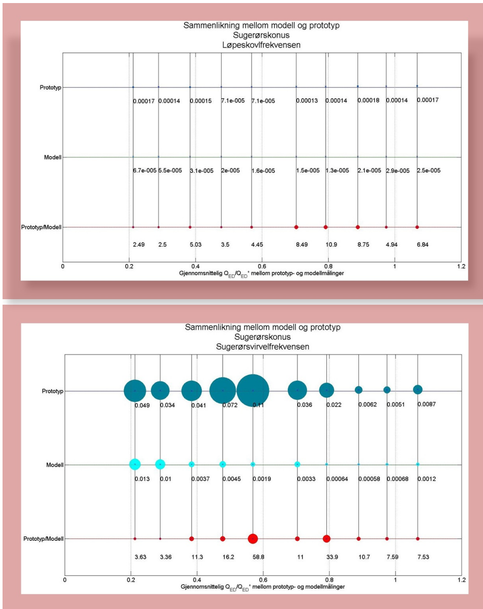
Figur 7.12: Sammenlikning i sugerørskonus. Øverst: Løpeskivfrekvens, nederst: Sugerørsvirvelfrekvens
