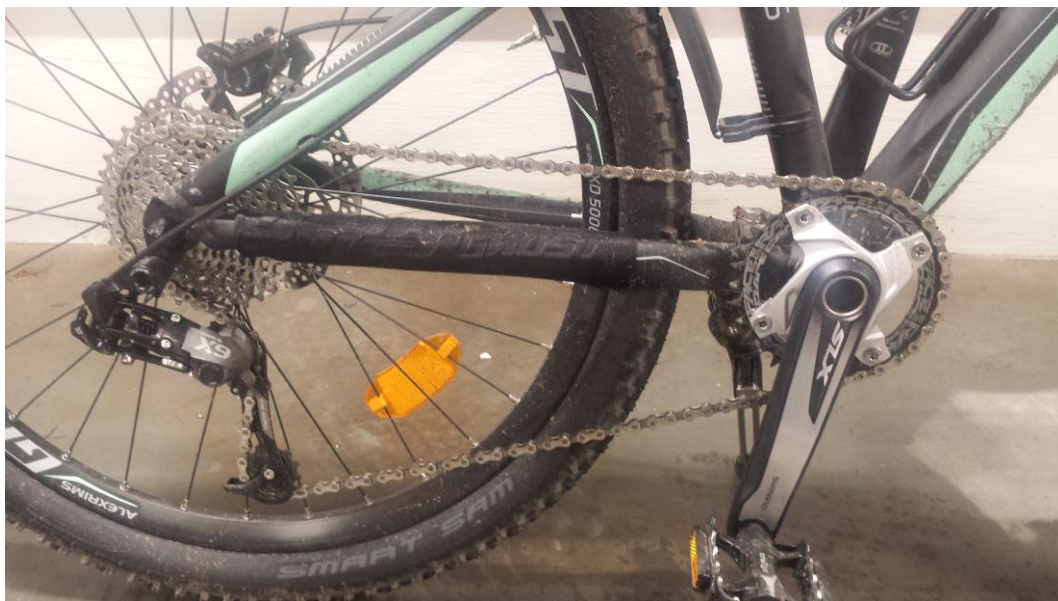
Figur 5: Drev med 32 tenner foran, 11-36 kassett bak.
