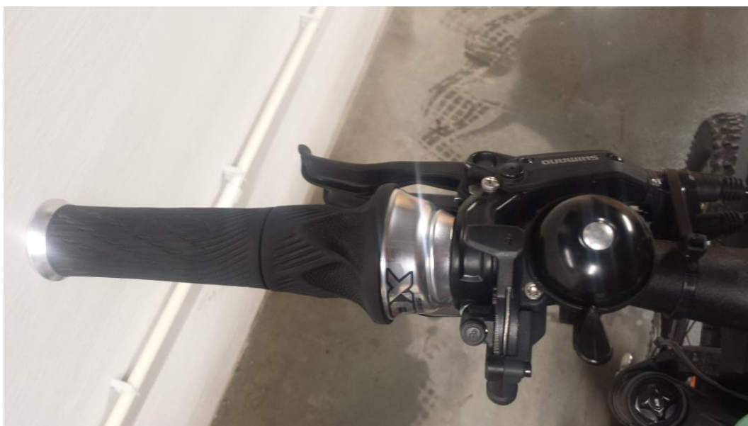
Figur 7: Grip-shift-giring på same side som bremsehendlane.
