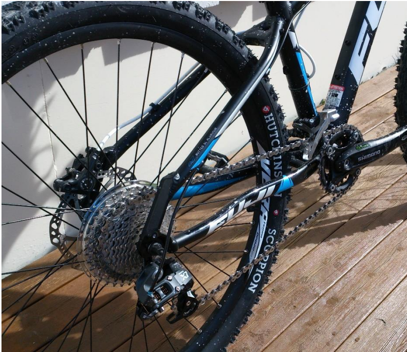
Figur 11 Ekstra tannhjul er montert bak.
