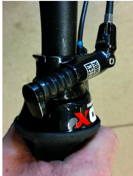
Figur 13 Hendelen som styrer setejusteringa.
