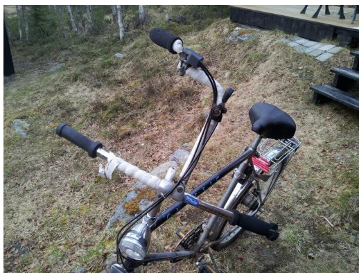
Figur 2: Gir med hakestyring, festa til sykkelstyret
