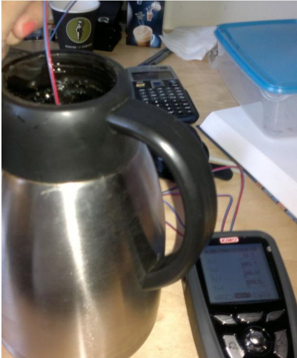
Figur 45 Test av termoelement i isvann
