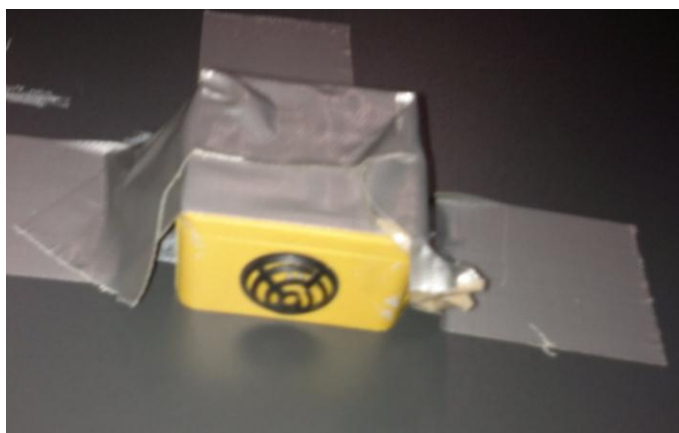
Figur 52 Datalogger fra TinyTag plassert på et arkivskap i E3
