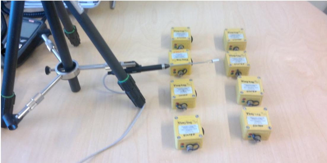
Figur 41 Test av lufttemperatur med måleutstyr fra TinyTag og Brüel&Kjær på eget kontor
