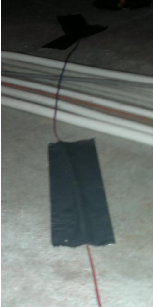
Figur 49 Termoelement plassert på overflaten til betongen i plenumet, 1
