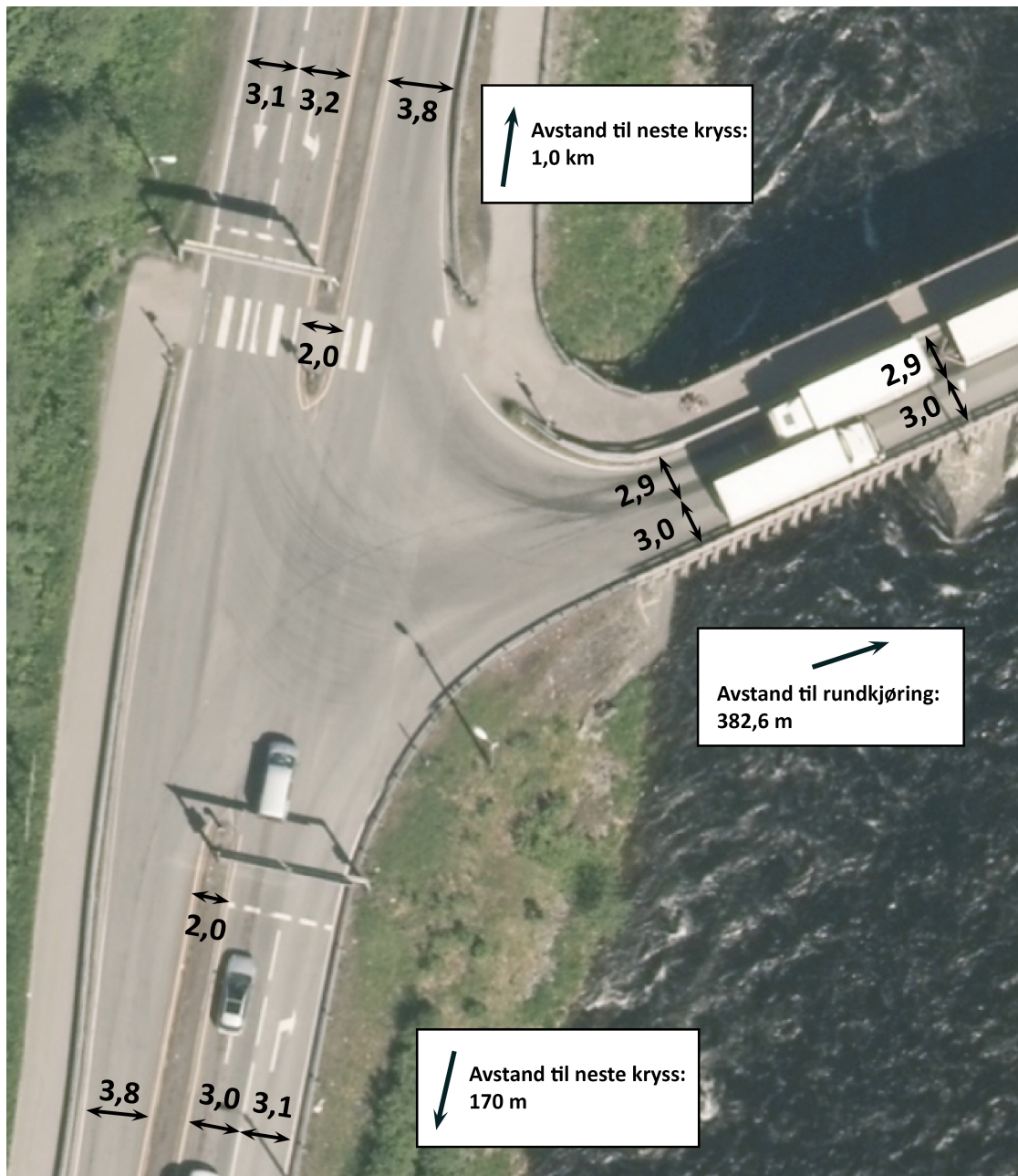
Figur 3.7: Geometri i signalregulert kryss
