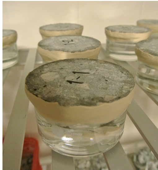
Figur 3-7 Bilde av oppsett ved koppmetoden. Betongskiven og prøvekoppen er tettet igjen med voks
