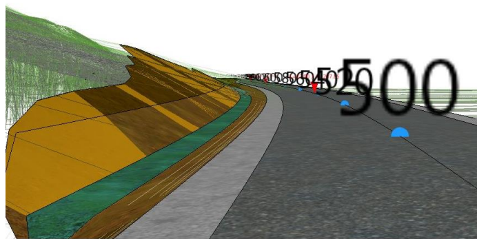
Figur 25. Eit alternativt grøfteprofil.
