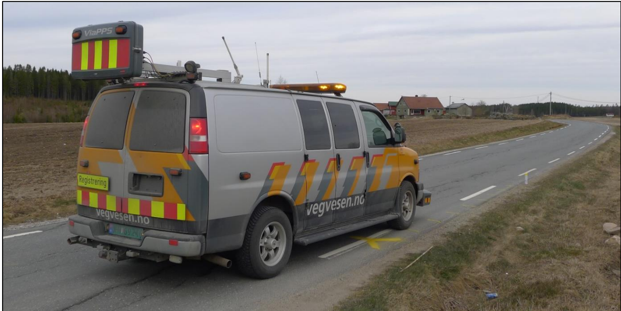
Figur 46 Foto av ViaPPS målebil med laser fra Cargoscan under feltarbeidet
