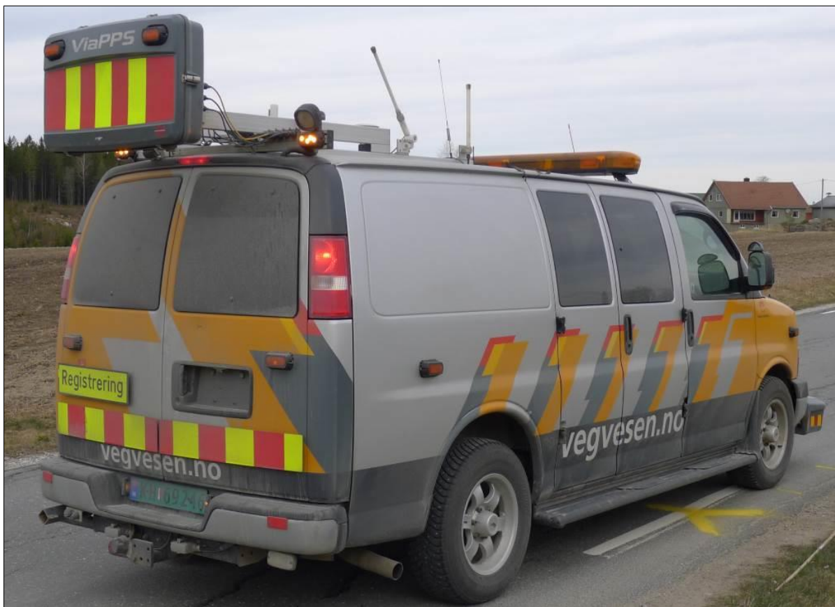
Figur 30 Foto av en ViaPPS målebil med Cargoscan-laser
