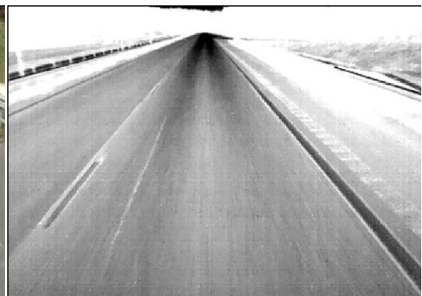
Figur 11 Bruk av varmekamera for identifisering av sprekker i vegflaten
