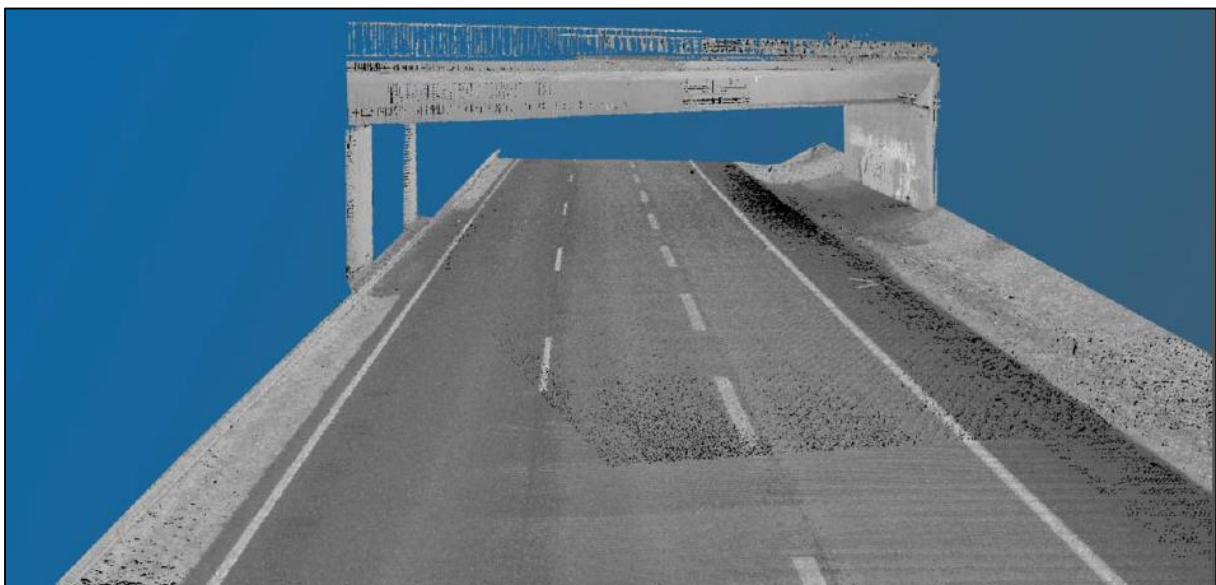
Figur 32 Illustrasjon av et 360 skann gjort med ZF-laser
