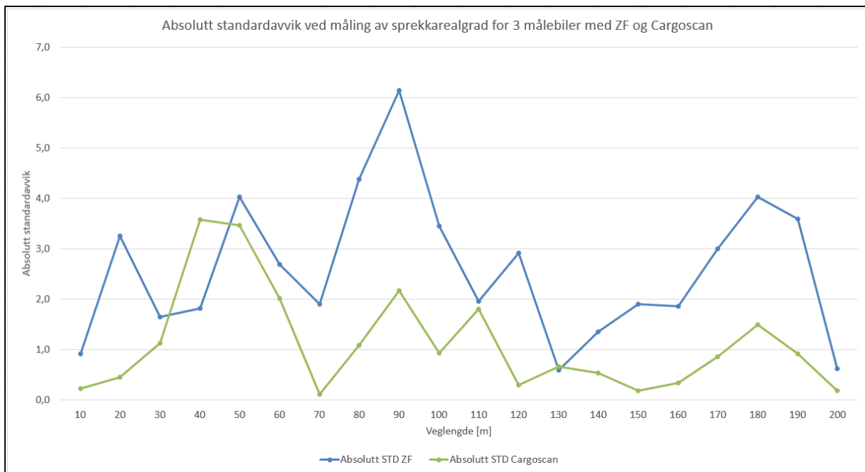
Figur 95 Absolutt avvik for gjennomsnittlig sprekkarealgrad for ZF og Cargoscan
