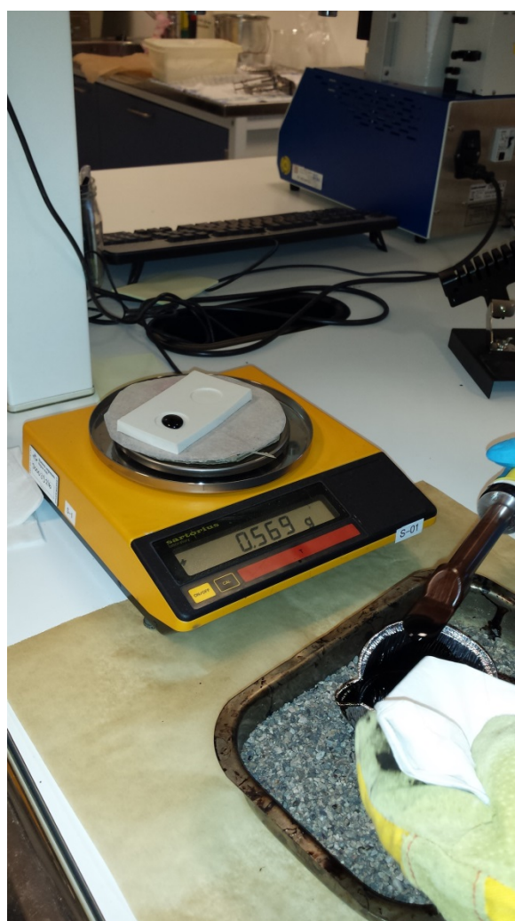
Kalibrering av apparatur og innstøping av bindemiddellinser til MSCR testing
