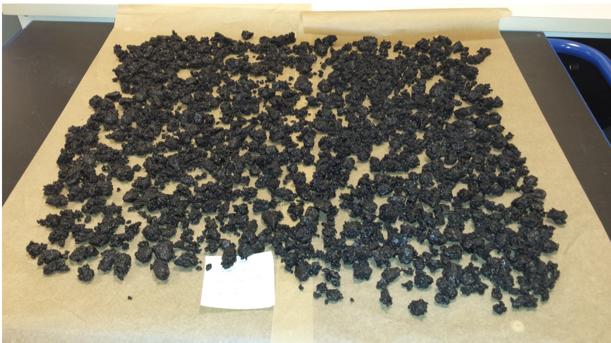
Figur 3.11 Masseprøve A er klargjort for ekstraksjon
