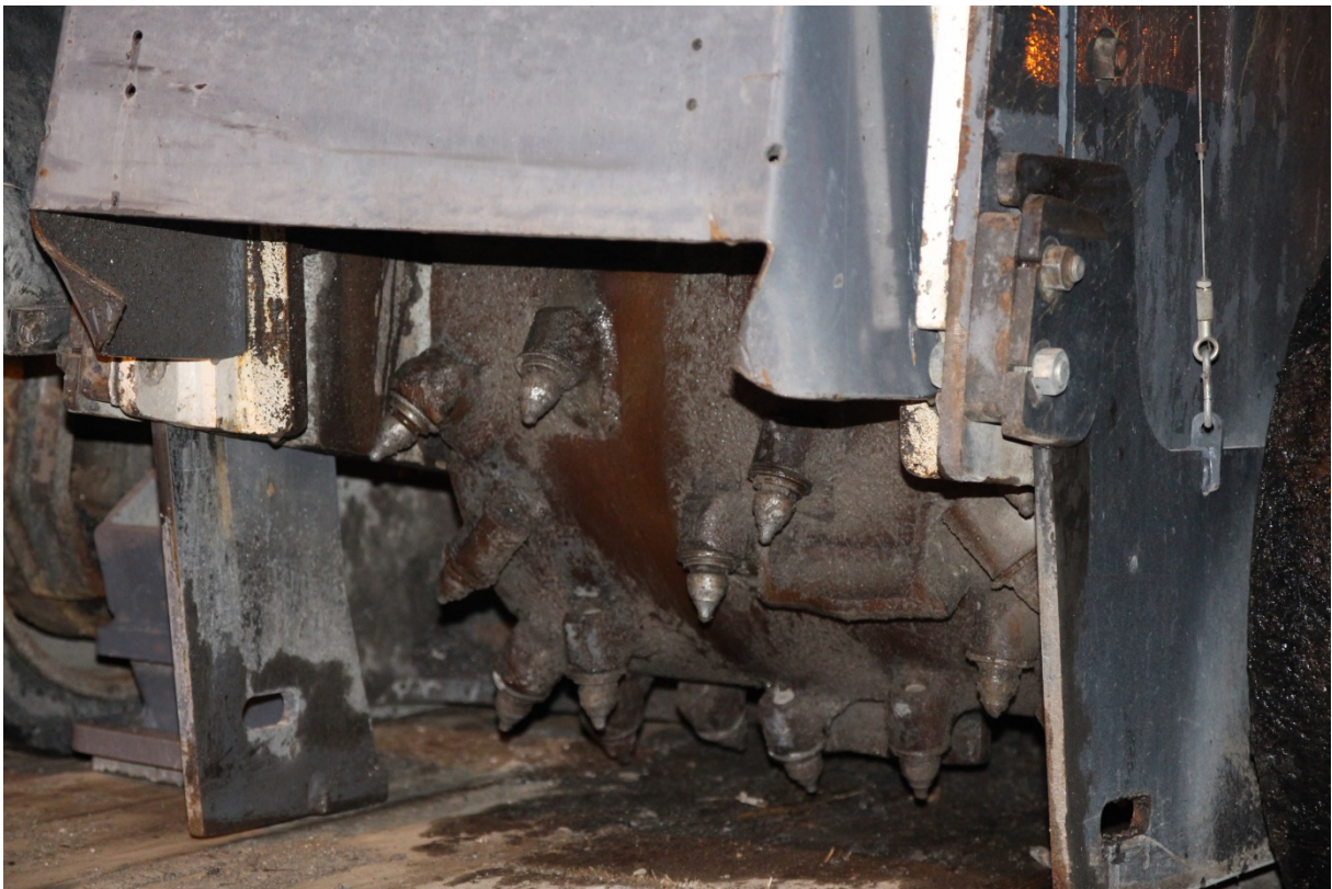
Figur 3.4 Fresetenner på en asfaltfreser (Foto: Karoline Vaager)
