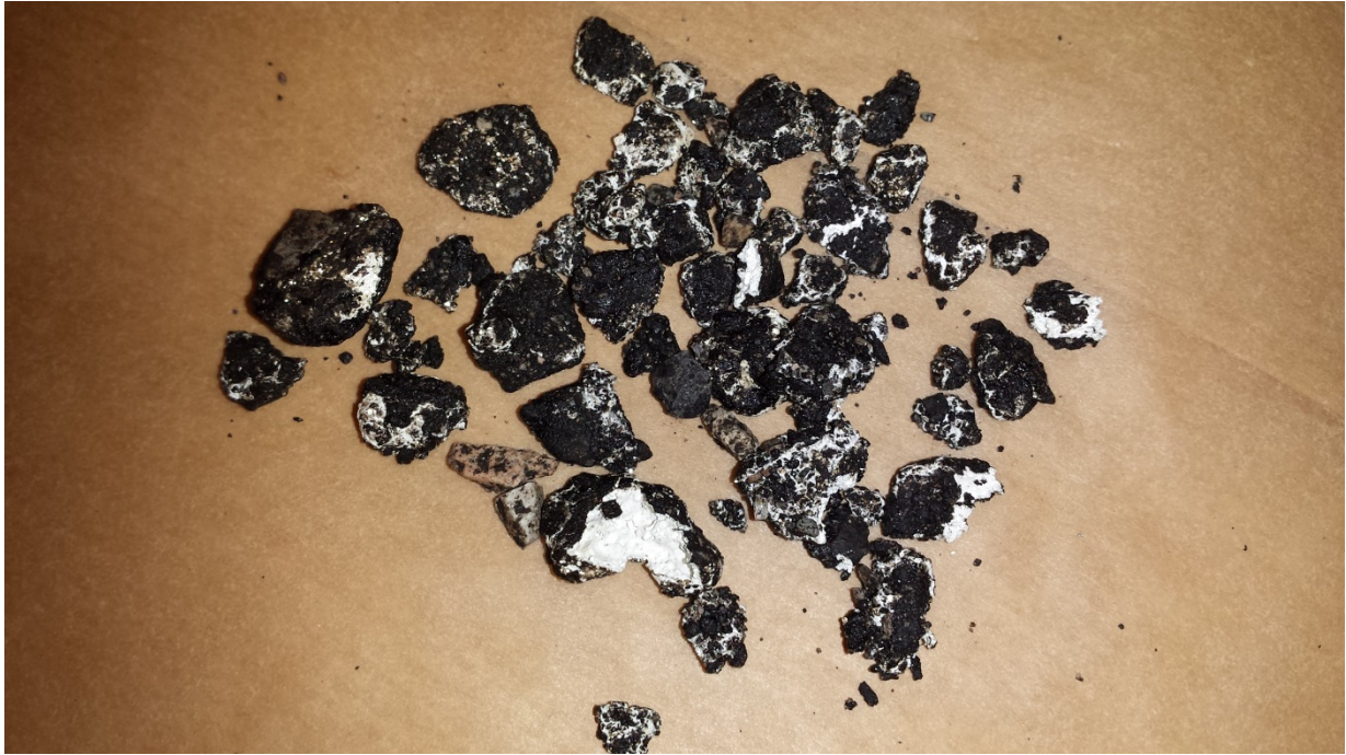
Figur 3.14 Klumper av vegmaling funnet i granulatprøven
