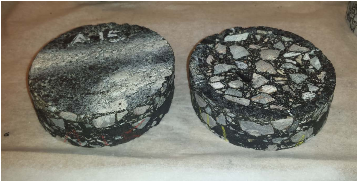
Figur 3.28 Reservekjerne A15 (venstre) og ferdig Prall-testet kjerne A14 (høyre)
