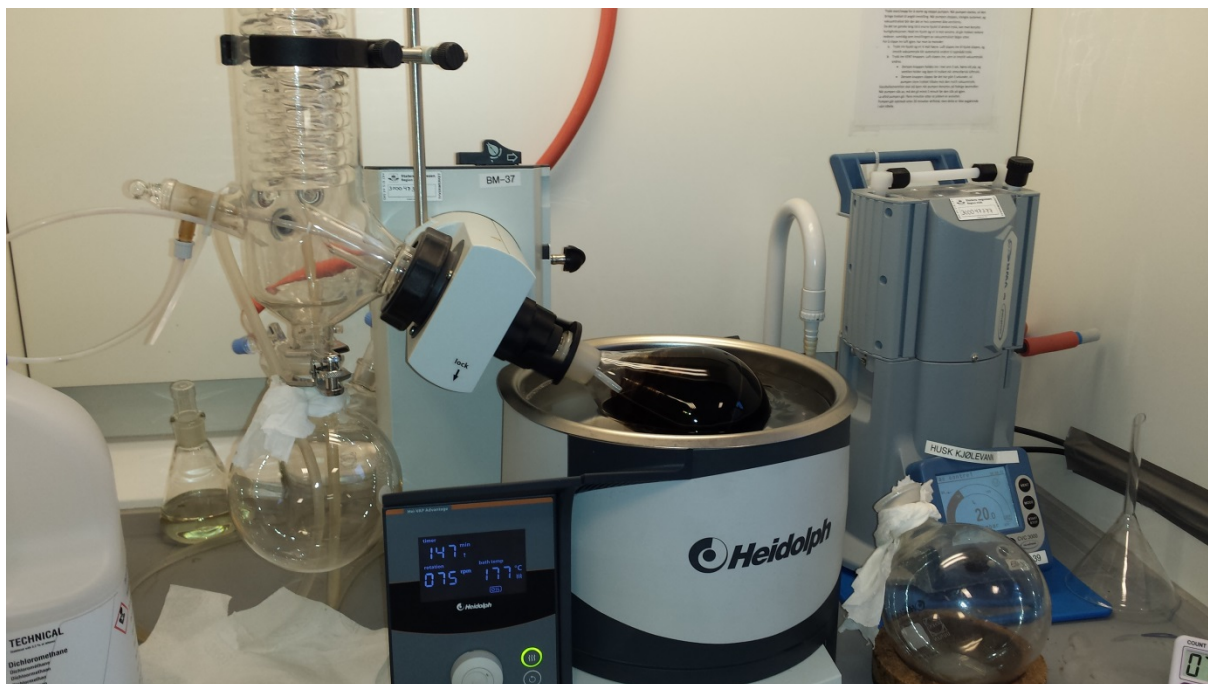
Figur 3.12 Inndamping av metylenklorid fra det ekstraherte bindemiddelet
