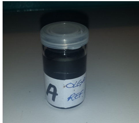
Figurene 3.20 og 3.21 Små prøvebegre med gjenvunnet bitumen ble sendt til Veidekke Industri AS for testing av Fraass bruddpunkt
