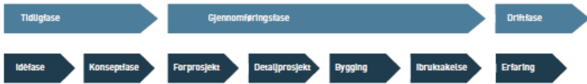
Figur 1 Faseinndeling fra sykehusbygging (Arge et al., 2010 1 ).
