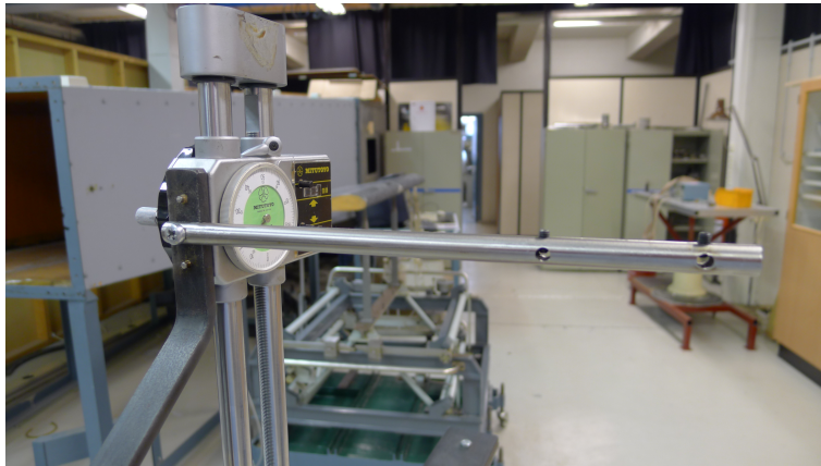
Figur 3.5: Monteringsrør for målesonder festet til traverseringsheis
