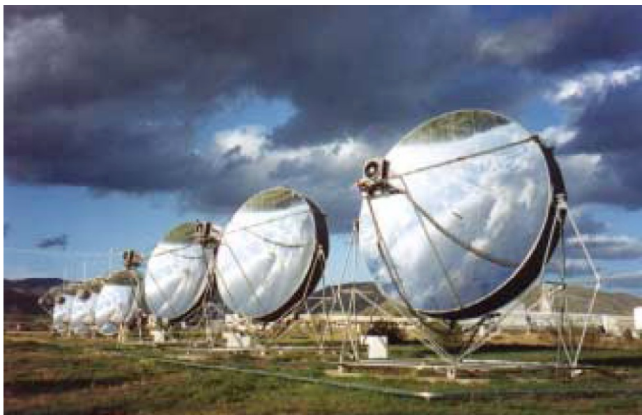
Figur 2-8 Parabolisk disksolfangarar. 6 stk 9kWe disk/stirling einingar under kontinuerlig driftssikkerhetstesting ved PSA-laboratoriet i Spania (Becker, Meinecke et al. 2000)
