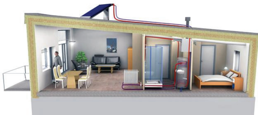
Figur 5-1 Snitt av passivhus med solfangar i Løvåshagen. [15]
