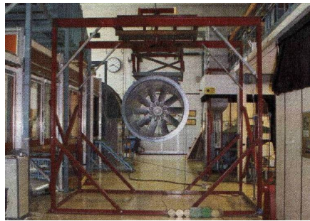
Figur 1.1: Den innkjøpte ventilatoren montert opp i testriggen ved instituttets laboratorie. Kilde: [5]
