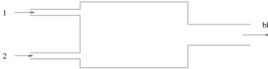
Figur 2.3: Blandekammer, definisjon av blandingsfraksjon
