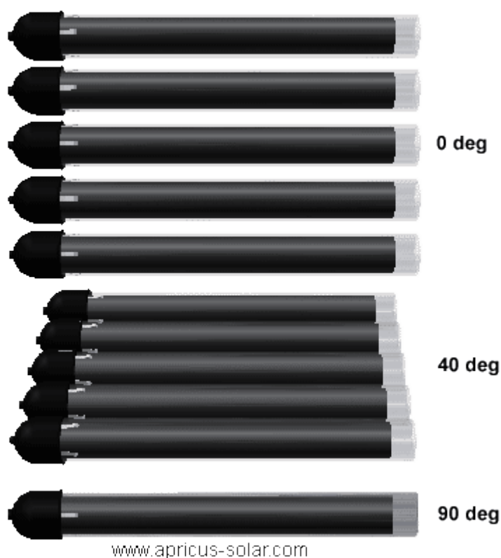
Figur 12.3. Vakuurrør sett rett ovenfra (0 °), sett fra 40 °, og sett fra 90° på det tversgående planet (Apricus Solar Hot Water, 2010).
