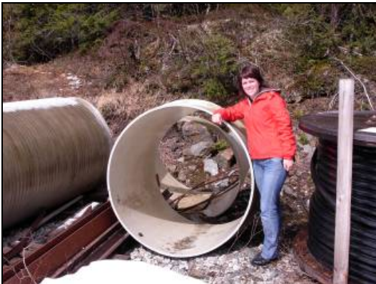
Bilde B-5 GUP-rør fra øvre del av vannveien. Ø=1340 mm
