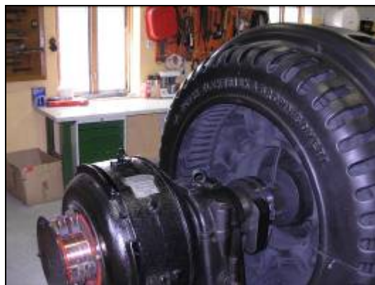
Bilde B-17 Generator med likestrømsmagnetisering
