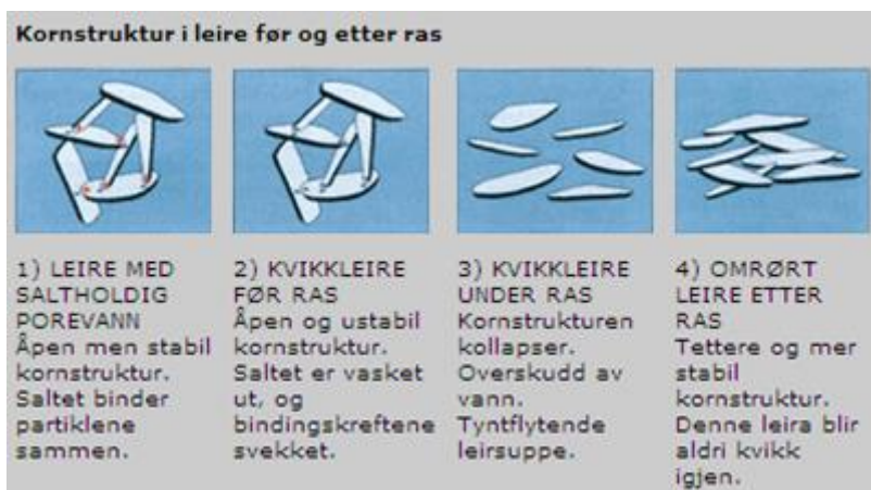
Figur 1: Illustrasjon av kornstruktur i kvikkleire (Husbyn et al., 2002)
