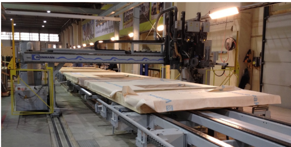
Figur 4.9. Spikermaskin fester klemlister og lekter til bindingsverket.
