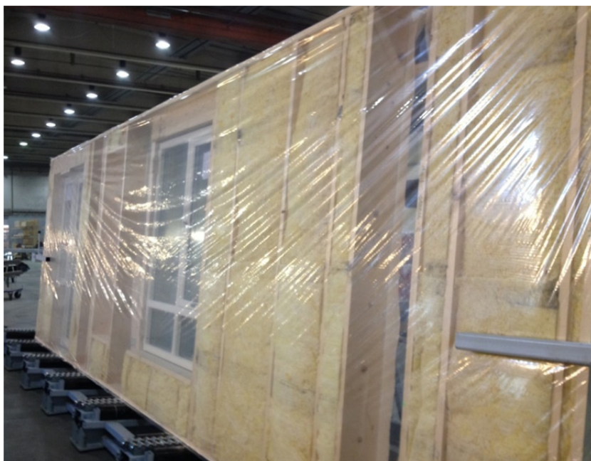
Figur 4.10. Yttervegelement klar for transport til byggeplass.
