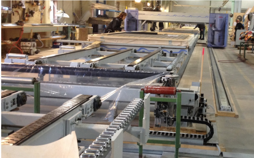
Figur 4.11. Produksjonslinje for lydvegger og bærende innervegger.
